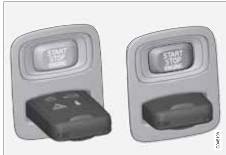
Замок запуска с выдвинутым/вставленным ключом зажигания.
