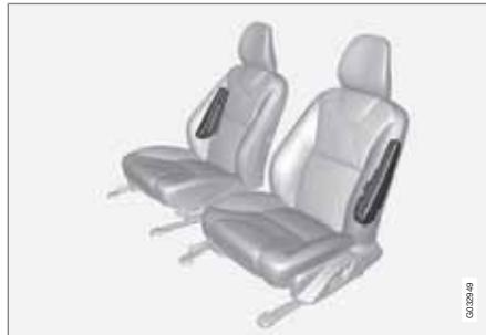
При боковом столкновении SIPS (Side Impact Protection System) направляет большую часть силы удара на балки, стойки, пол, крышу и другие элементы кузова автомобиля. Боковые подушки безопасности на стороне водителя и пассажира защищают грудь и бедра и являются важным элементом системы SIPS.
