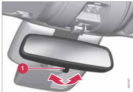
**1** Установка противоослепляющего положения
