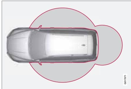
на расстоянии не более прим. 1,5 м от дверной ручки или дверь задка автомобиля. Это означает, что тот, кто собирается запереть или отпереть дверь должен иметь РСС с собой. Нельзя запереть или отпереть дверь, если РСС находится по другую сторону автомобиля.
