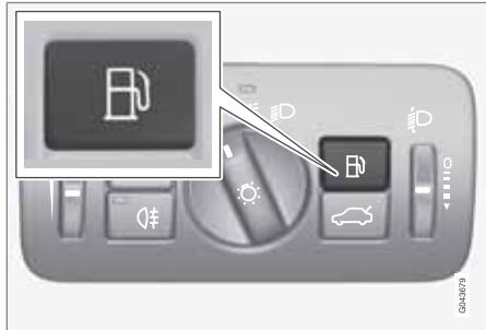
Откройте крышку топливного бака кнопкой на панели освещения – крышка откроется, когда вы отпустите кнопку.
