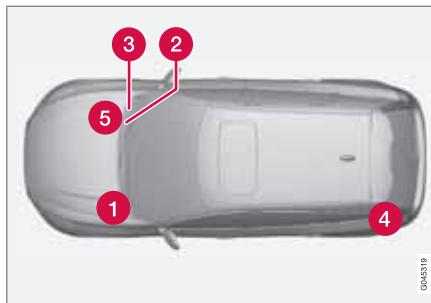
Расположение токораспределительных коробок в автомобиле с левосторонним управлением. В автомобиле с правосторонним управлением токораспределительные
