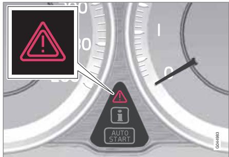
Если автомобиль участвовал в столкновении, на информационном дисплее может появиться текст **Аварийный режим См. руководство**. Это означает, что не все функции автомобиля выполняются в полном объеме. Режим безопасности это защита, которая задействуется, когда во время столкновения могли быть повреждены важные функции автомобиля, например, топливопроводы, датчики одной из систем защиты или система тормозов.
