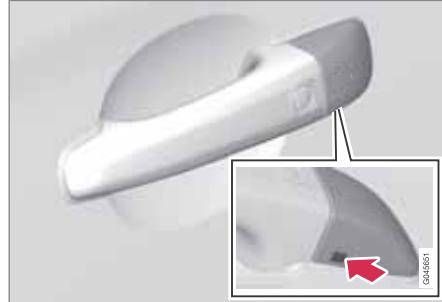
Замочная скважина под плоский вставной ключ – для снятия крышки.
