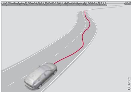
DAC предназначен для обнаружения незаметного ухудшения поведения водителя и в первую очередь пригоден для использования на крупных магистралях. Функция не предназначена для езды по городу.
