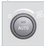
Для увеличения уменьшения скорости вентилятора поверните ручку. Если выбирается **AUTO**, скорость вентилятора устанавливается автоматически. Ранее установленная скорость вентилятора отменяется.
