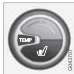
Максимальный обогрев включается, если на клавишу нажать один раз – три оранжевые лампы светятся на мониторе центральной консоли (см. рисунок выше).
