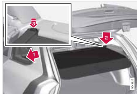
Растяните защитную шторку поверх груза и закрепите крючками в пазах у задних стоек грузового отсека.
