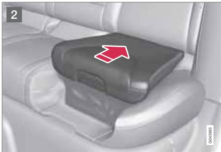
**2** Для фиксирования вдавите опорную подушку назад.
