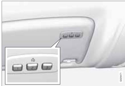
HomeLink® – это программируемый дистанционный пульт, с помощью которого можно управлять работой до трех различных устройств (например, ворота гаража, система охранной сигнализации, освещение внутри и снаружи помещения и т.п.), заменяя, таким образом, пульты дистанционного управления этих устройств. HomeLink® встроен в левый солнцезащитный козырек.
