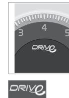
Отключение функции Start/Stop сопровождается отключением символа на информационном дисплее и отображением в течение прим. 5 секунд сообщения **Автостарт-стоп выключен** – при этом лампа в кнопке гаснет.
