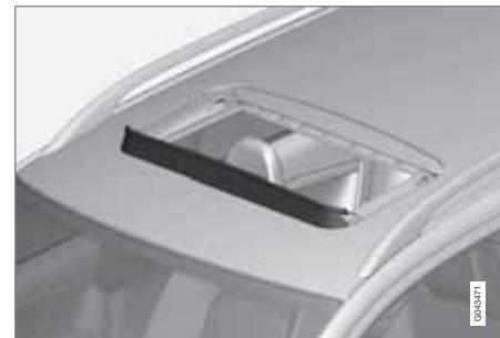
В люке крыши имеется воздухоотражатель, который откидывается, когда люк открыт.
