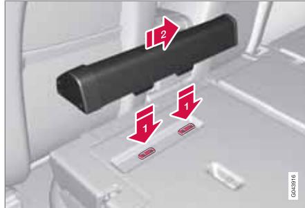
Двухсекционная кассета с защитной сеткой крепится сзади на спинке сидения. Узкая кассета крепится на левой стороне (если смотреть со стороны двери задка).
