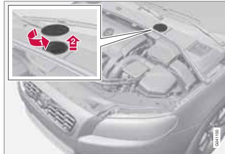
Расположение бачка с тормозной жидкостью.
