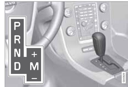
**D:** Положения в автоматическом режиме. **M (+/-):** Положения в ручном режиме.
