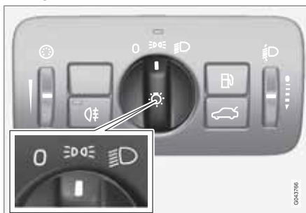
Ручка регулировки света в положении для габаритных/стояночных огней.
