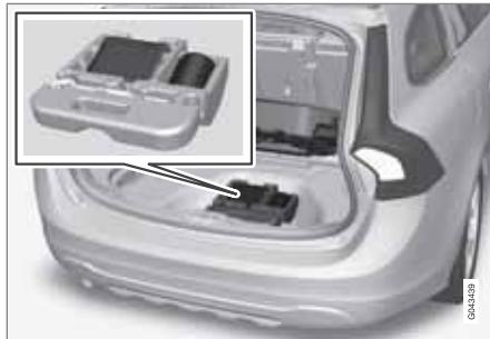
Временный шиноремонтный комплект (TMK; Temporary Mobility Kit) используется для герметизации прокола, а также проверки и регулировки давления в шинах. Комплект состоит из компрессора и упаковки с жидким герметиком, и предназначен для проведения временного ремонта. Банка с жидким герметиком должна заменяться до истечения срока годности и после герметизации шины.
