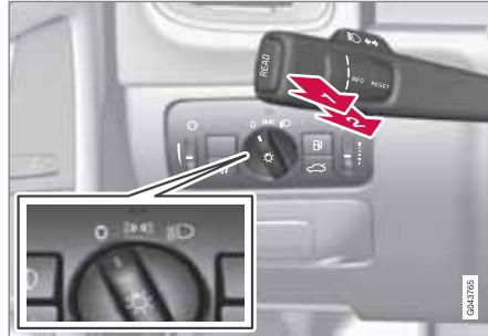
Ручка регулировки света и подрулевой рычаг.
