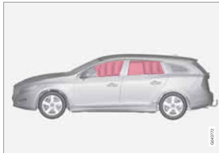
Надувной занавес IC (Inflatable Curtain) является составной частью SIPS и подушек безопасности. Он смонтирован в облицовке потолка вдоль боковых автомобилей и защищает пассажиров на внешних местах в автомобиле. При достаточно сильном столкновении датчики реагируют, и занавес надувается. Надувной занавес помогает во время столкновения защитить голову водителя и пассажиров от ударов о внутренние поверхности автомобиля.
