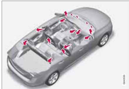
Поступающий воздух распределяется между различными соплами салона.
