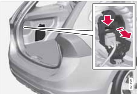
Лампа заднего хода, противотуманного света и мигающих сигналов в задней комбинации заменяется изнутри багажного отделения.
