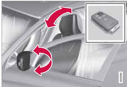
Когда автомобиль отпирается тем же дистанционным ключом, которым он запирался, и открывается дверь водителя, кресло водителя и внешние зеркала заднего вида автоматически устанавливаются в положения, хранящиеся в памяти ключа.
