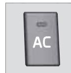
Когда в клавише **AC** горит лампа, кондиционирование воздуха работает в автоматическом режиме. В этом случае поступающий воздух охлаждается и подсушивается.
