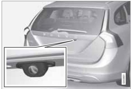
Камера установлена вблизи ручки открытия крышки.
