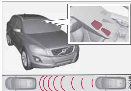
Приемно-выходное окно лазерного датчика<sup>1</sup>.
