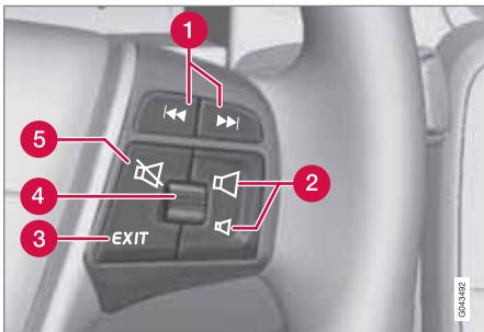
**1** Краткое нажатие используется для перемещения по дорожкам компакт-диска или запрограммированным радиостанциям<sup>2</sup>. Длительное нажатие используется для быстрой прокрутки дорожек на компакт-диске.
