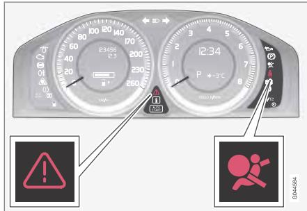
Предупреждающий символ в комбинированном приборе включается, когда дистанционный ключ находится в положении II или III. Этот символ гаснет примерно через 6 секунд, если система надувных подушек безопасности исправна.
