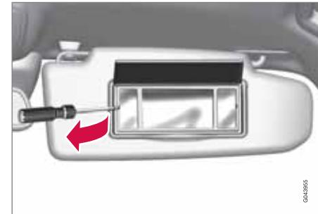
1. Вставьте отвертку под край плафона лампы и осторожно отогните вверх выступ.
