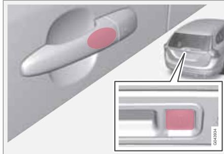
В автомобилях с системой без ключа Keyless имеется сенсорная зона на внешних дверных ручках, а также обрезиненная клавиша около обрезиненной нажимной пластины двери задка.
