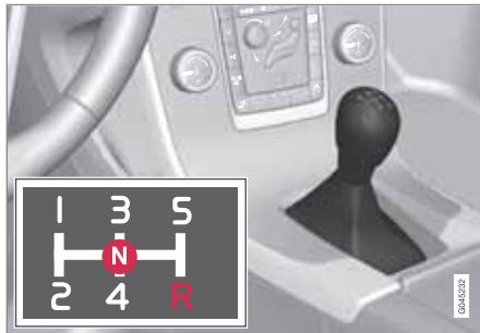
Схема переключения передач, 5-ступенчатая коробка передач.
