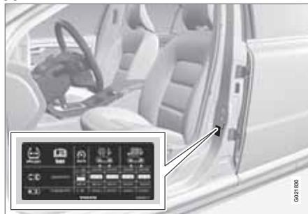
На наклейке, расположенной на дверной стойке со стороны водителя (между передней и задней дверью) указано давление в шинах при различной нагрузке и скоростях. Эта же информация приведена в таблице давления в шинах, см. стр. 402.
