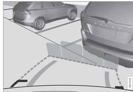
Если в автомобиле также установлены парковочные датчики (см. стр. 231), расстояния будут показываться более точно, а окрашенные зоны укажут, какой/какие из 4-х датчиков регистрируют препятствие.
