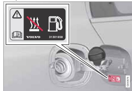
Предупреждающая табличка на крышки топливного бака.
