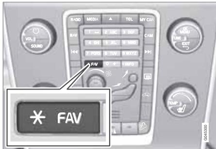
Кнопку **FAV** можно использовать для сохранения функций, которые вы часто используете, с тем, чтобы такая функция легко запускалась нажатием кнопки **FAV**. Для каждой функции вы можете выбрать одну позицию-фаворита (например, **Эквалайзер**), как показано ниже:
