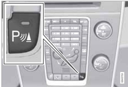
Система включается автоматически в момент запуска двигателя – горит лампа в выключателе Выкл/Вкл. Если помощь при парковке отключить кнопкой, лампа гаснет.
