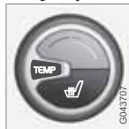
Ручкой вы можете устанавливать температуру. Для ECC\* температура на стороне водителя и пассажира может устанавливаться независимо.
