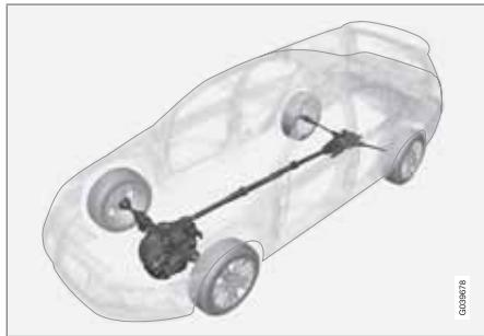
Привод на четыре колеса означает, что автомобиль приводится в движение одновременно всеми четырьмя колесами.
