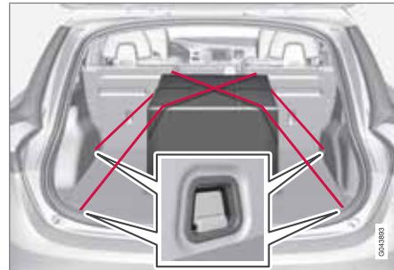
Откидные проушины для крепления груза используются для фиксации стяжных лент, закрепляющих предметы в грузовом отделении.
