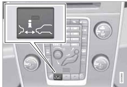
Чтобы включить или отключить функцию, нажмите кнопку в центральной консоли. Если в кнопке горит лампа – функция включена.
