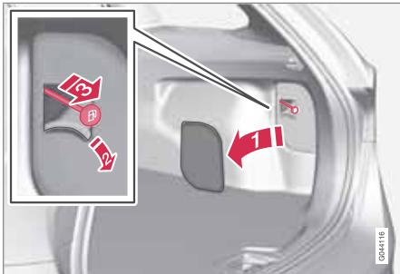
Крышку топливного бака можно открыть вручную, если электрический замок не срабатывает из салона.
