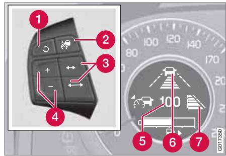
Кнопки на рулевом колесе<sup>5</sup> и дисплей.
