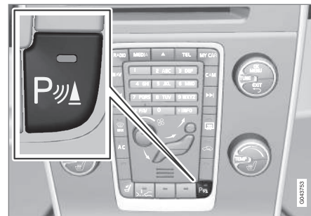
Automāšinas novietošanas sensoru un CTA sensoru ieslēgšana/izslēgšana*.
