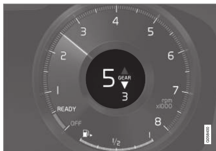
Fokozatváltás-jelző a 12-hüvelykes járművezetői kijelzőn*.
