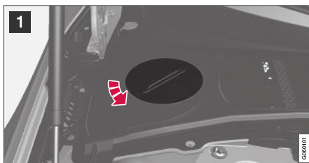
Hűtőfolyadék tágulási tartálya, balkormányos autó.
