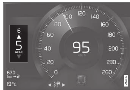
Fokozatváltás-jelző a 8-hüvelykes járművezetői kijelzőn.
