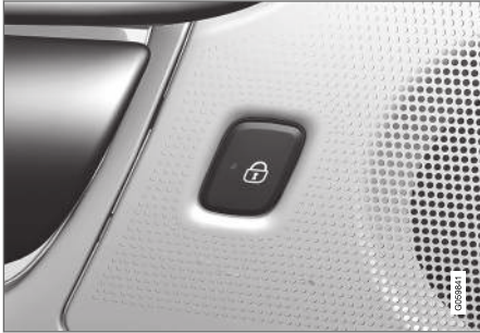
Záró gombok visszajelző lámpával a hátsó ajtóban.
