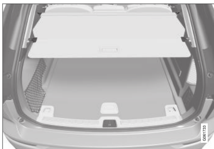
Csomagtértakaró teljesen takaró helyzetben.
