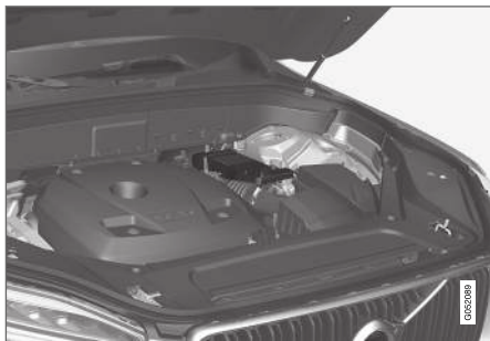
A segédakkumulátor egy dobozban helyezkedik el a felüglesztéstorony mellett.
