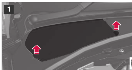
Hűtőfolyadék tágulási tartálya, jobbkormányos autó.
