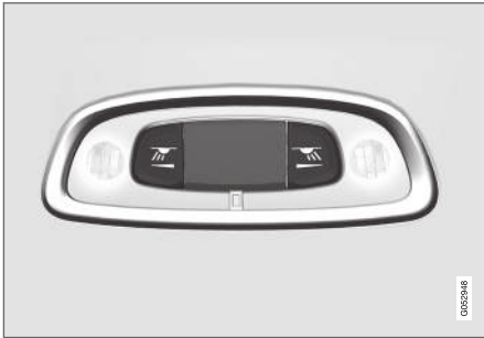
Olvasólámpák a hátsó ülés felett.
