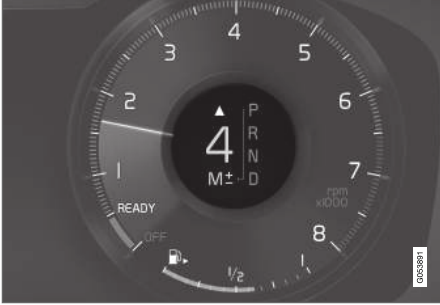
12 inç sürücü ekranındaki vites değiştirme göstergesi*.
