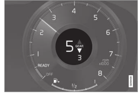
12 inç sürücü ekranındaki vites değiştirme göstergesi*.
