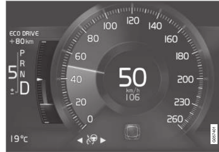
8 inç sürücü gösterge ekranındaki Eco göstergesi.
