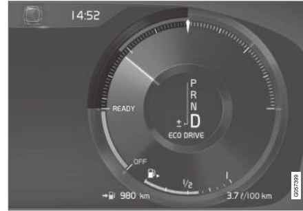
12 inç sürücü ekranındaki Eco göstergesi*.
