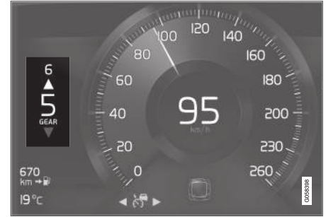
8 inç sürücü göstergesi ekranındaki vites değiştirme göstergesi.
