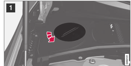
Vase d'expansion du système de refroidissement, voiture à conduite à gauche.
