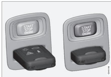
Замок запуска с выдвинутым/вставленным ключом зажигания.
