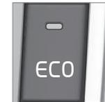
При отключении функции ECO в комбинационном приборе гаснет символ ECO и лампа в кнопке ECO. Функция выключена до тех пор, пока она не включается нажатием кнопки ECO.
