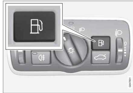
Откройте крышку топливного бака кнопкой на панели освещения – крышка откроется, когда вы отпустите кнопку.
