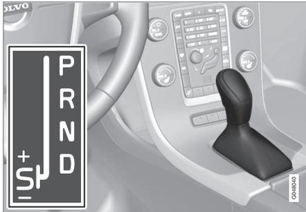
**D:** Положения передач в автоматическом режиме. **+S-**: Положения передач в ручном режиме. **S:** Режим Sport\*.
