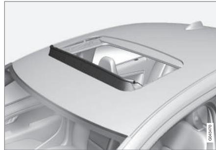
В люке крыши имеется воздухоотражатель, который откидывается, когда люк открыт.
