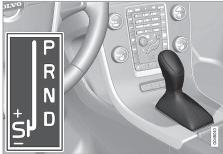
**D:** Положения передач в автоматическом режиме. **+/-:** Положения передач в ручном режиме. **S<sup>±</sup>:** Режим Sport\*.
