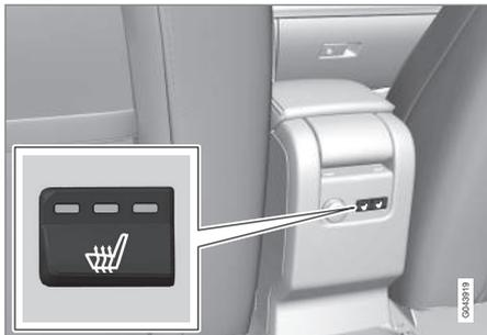
Заданный уровень обогрева отображается количеством включенных в кнопке ламп.
