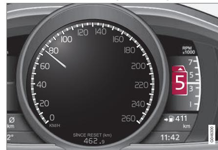
Комбинированный прибор "Digital" с индикатором переключения передач.
