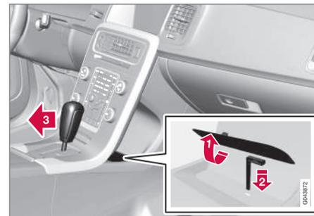
Если автомобиль находится в нерабочем состоянии, например, разряжен пусковой аккумулятор, то для перемещения автомобиля необходимо вывести селектор передач из положения **P**.
