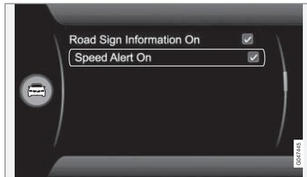
Водитель может выбрать, следует ли получать предупреждение, когда действующее ограничение скорости превышает на 5 км/ч или больше. Предупреждение о превышении скорости выдается в виде мигающего символа с указанием текущей максимальной скорости. Функцию можно активировать/отключить в системе меню **MY CAR**. Описание системы меню - см. MY CAR (стр. 113).
