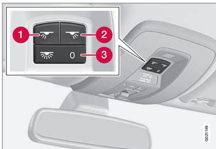
Кнопки управления в потолочной консоли передними лампами для чтения и освещением салона.
