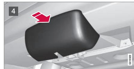
4 Задвинув, зафиксируйте защитную крышку.
