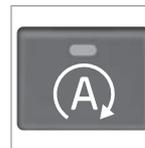
Функция Start/Stop активируется автоматически после запуска двигателя ключом. Для привлечения внимания водителя в комбинированном приборе появляется символ этой функции и включается лампа в кнопке Вкл./Выкл..
