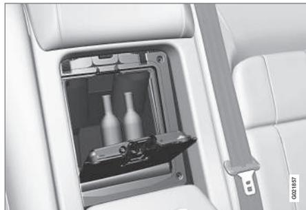
Холодильник расположен за подлокотником заднего сидения. Он действует, когда двигатель работает или дистанционный ключ установлен в положение II.
