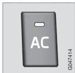
Когда в клавише **AC** горит лампа, кондиционирование воздуха работает в автоматическом режиме.
