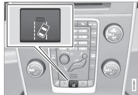
LDW включается или выключается кнопкой на центральной консоли. Лампа в кнопке горит, когда функция включена.
