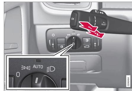
Подрулевой рычаг и ручка регулировки света.
