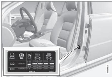
На наклейке, расположенной на дверной стойке со стороны водителя (между передней и задней дверью) указано давление в шинах при различной нагрузке и скоростях. Эта же информация приведена в таблице давления в шинах, см. Шины - заданное давление в шинах (стр. 420).
