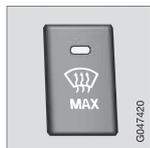
При включенной функции горит лампа в кнопке дефростера.
