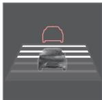
Вы можете выбрать различный временной интервал до автомобиля впереди вас, который отображается в комбинированном приборе в виде 1-5 горизонтальных штрихов – чем
