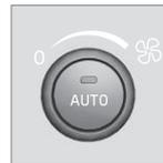
Для увеличения уменьшения скорости вентилятора поверните ручку. При выборе **AUTO** скорость вращения вентилятора регулируется автоматически (стр. 136) – ранее
