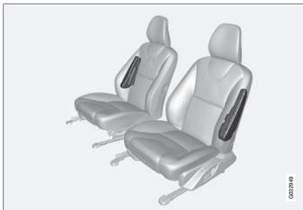
Система SIPS-bag состоит из двух основных частей: боковой подушки безопасности и датчиков. Боковая подушка безопасности смонтирована на раме спинки переднего сидения.
