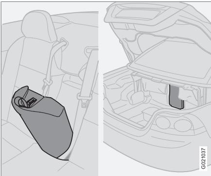
Для удобства транспортировки длинномерных, легких предметов в спинке заднего сидения позади центральной панели<sup>1</sup> имеется люк.
