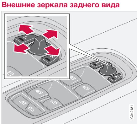
Переключатели установки двух наружных зеркал находятся на передней части подлокотника на двери водителя. Зеркала заднего вида можно устанавливать, когда ключ находится в положении I и II.
