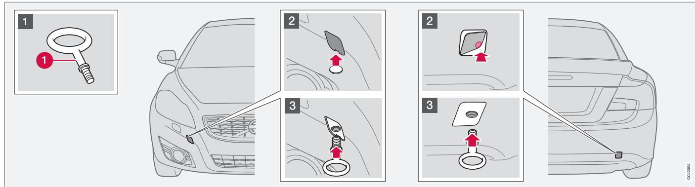
Буксировочная скоба вкручивается и закрепляется в гнезде с резьбой под защитной крышкой с правой стороны на переднем или заднем бампере.
