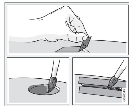
Перед началом работ по восстановлению лакокрасочного покрытия автомобиль необходимо вымыть и высушить, а его температура должна быть выше 15 °C.
