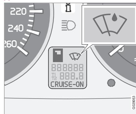
Датчик дождя контролирует количество воды на ветровом стекле и автоматически активирует стеклоочистители. Чувствительность датчика дождя изменяется при помощи регулировочного кольца (2), см. стр. 73.
