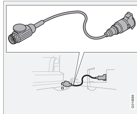
Если буксирное устройство автомобиля оборудовано 13-штекерным разъемом, а прицеп 7-штекерным разъемом, необходим специальный переходник. Используйте переходный кабель, одобренный Volvo. Проверьте, чтобы кабель не волочился по земле.
