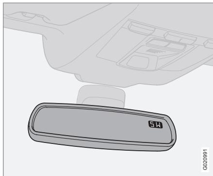
В верхнем правом углу зеркала заднего вида установлен дисплей, который показывает, в каком направлении по компасу направлена передняя часть автомобиля. Восемь различных направлений обозначаются сокращениями на английском языке: N (север),
