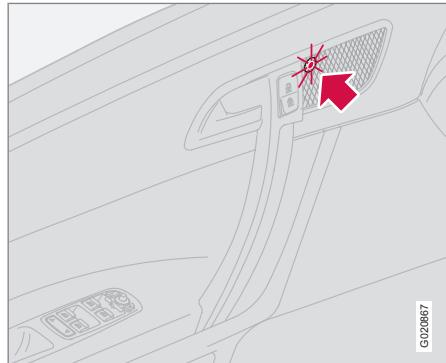
После того, как при выключенном двигателе автомобиль заперт кнопкой запирания на дистанционном ключе или системой Keyless drive, с внутренней стороны соответствующей двери в течение примерно 5 минут горит лампа, см. стр. 140.
