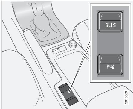
Кнопка Вкл/Выкл (в данном примере задняя кнопка).
