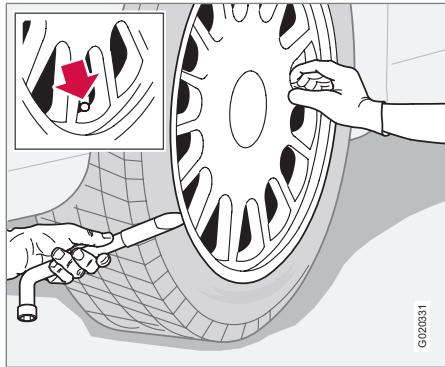
Выставьте треугольный знак аварийной остановки, если замена колеса должна быть проведена в зоне движения транспорта. Убедитесь, что автомобиль и домкрат находятся на твердой горизонтальной поверхности.
