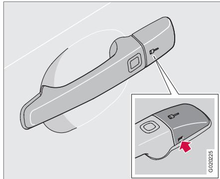
Если центральный замок не срабатывает от дистанционного ключа, например, из-за разряженной батарейки, дверь водителя можно открыть следующим образом:
