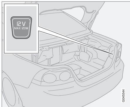
Для доступа к электрическому гнезду откиньте крышку. Питание на гнездо подается независимо от того, включено зажигание или нет.
