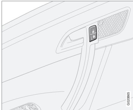
Центральной кнопкой на дверях вы можете одновременно запереть или отпереть двери и крышку багажника.
