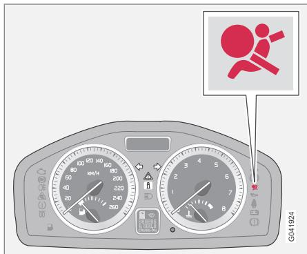
Предупреждающий символ в комбинированном приборе включается при повороте дистанционного ключа в положение I, II или III. Этот символ гаснет прим. через 6 секунд, если система надувных подушек безопасности исправна.
