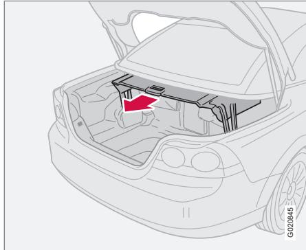
Данная перегородка ограничивает количество груза в багажном отделении для беспрепятственного перемещения крыши. Внимательно следите за тем, чтобы перегородка в багажнике была полностью закрыта и зафиксирована, как с левой, так и с правой стороны.
