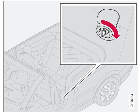
Если электрическая система автомобиля временно не работает, крышку багажника можно открыть механическим путем с помощью вставного плоского ключа из дистанционного ключа. Информацию о вставном плоском ключе см. стр. 135.
