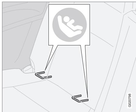
Точки крепления системы ISOFIX спрятаны сзади в нижней части спинки внешних мест заднего сидения.
