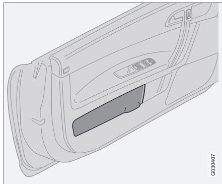
Чтобы открыть отделение для хранения, поднимите нижний край крышки, а чтобы закрыть - слегка надавите на верхнюю часть крышки.
