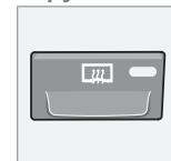
Обогрев используется для удаления обледенения и запотевания с заднего стекла и зеркал заднего вида. Если нажать один раз на кнопку, одновременно начинается обогрев заднего стекла и зеркал заднего вида. Если в кнопке горит лампа – функция активирована.
