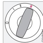
Активируется стартер. После пуска двигателя дистанционный ключ отпускается и отпружинивает назад в положение движения.
