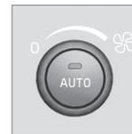
Для увеличения уменьшения скорости вентилятора поверните ручку. При выборе **AUTO** скорость вращения вентилятора регулируется автоматически (стр. 148) - ранее
