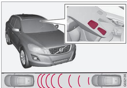
Приемно-выходное окно лазерного датчика<sup>12</sup>.
