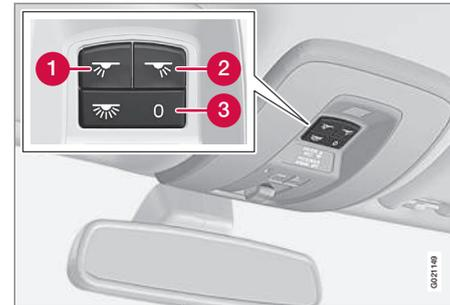
Кнопки управления в потолочной консоли передними лампами для чтения и освещением салона.
