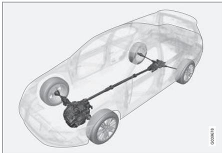
Привод на четыре колеса (All Wheel Drive) означает, что автомобиль приводится в движение одновременно всеми четырьмя колесами.
