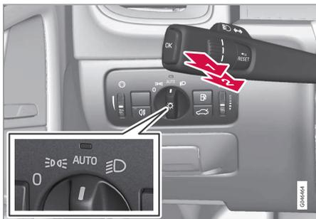
Подрулевой рычаг и ручка регулировки света.
