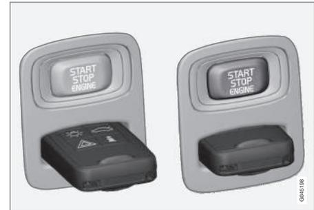
Дистанционный ключ отжат/вставлен в замок запуска и кнопка **START/STOP ENGINE**.
