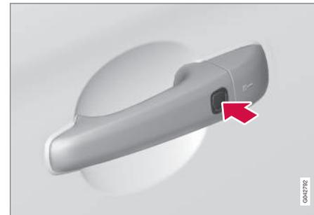
В автомобилях с системой Keyless во внешних дверных ручках имеется кнопка.
