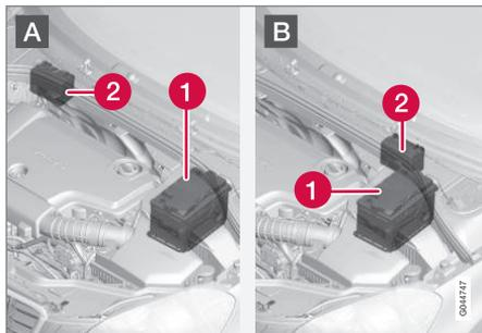
А: Автомобиль с левосторонним управлением. В: Автомобиль с правосторонним управлением. (1) Пусковой аккумулятор<sup>14</sup> (2) Вспомогательный аккумулятор.
