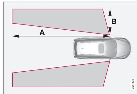
$A = \text{прим. } 9,5 \text{ м}$  и  $B = \text{прим. } 3,0 \text{ м}$ .
