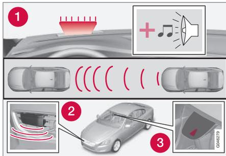
1. Акустический и визуальный предупреждающий сигнал в случае опасности столкновения.
