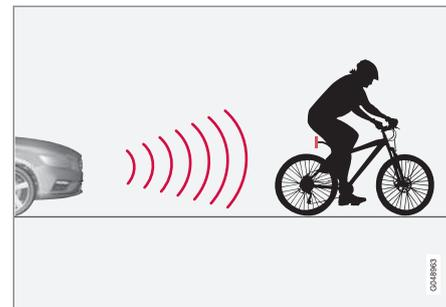
Функция "узнает" велосипедистов только сзади и в том случае, когда они движутся в одном направлении с автомобилем.
