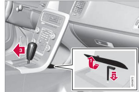
Если автомобиль находится в нерабочем состоянии, например, разряжен пусковой аккумулятор, то для перемещения автомобиля необходимо вывести селектор передач из положения **P**.
