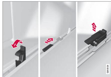
Крепежные скобы можно легко снять с шины, например, для чистки основания шины.
