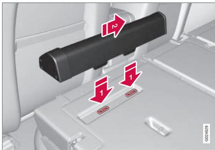
Двухсекционная кассета с защитной сеткой крепится сзади на спинке сидения. Узкая кассета крепится на левой стороне (если смотреть со стороны двери задка).
