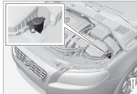
Омыватели ветрового стекла и фар имеют общий бачок с жидкостью.
