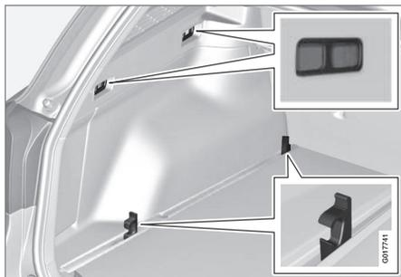
Расположение точек крепления в грузовом отсеке (с подвижными крепежными скобами).
