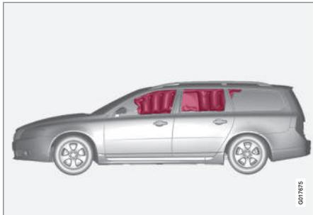
Надувной занавес IC (Inflatable Curtain) входит в систему SIPS (стр. 37) и систему подушек безопасности (стр. 32). Он смонтирован в облицовке потолка вдоль боковин автомобиля и защищает пассажиров на внешних местах в автомобиле. При достаточно сильном столкновении датчики реагируют, и занавес надувается.
