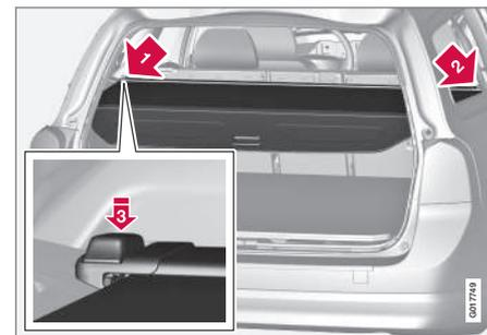
Растяните защитную шторку поверх груза и закрепите крючками в пазах у задних стоек грузового отсека.
