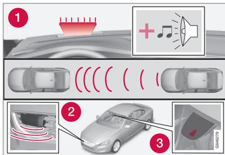
1. Индикаторная лампа и звуковой сигнал системы предупреждения о столкновении<sup>5</sup>.
