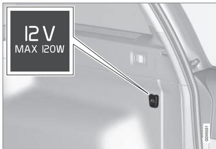
Для доступа к электрическому гнезду откиньте крышку.
