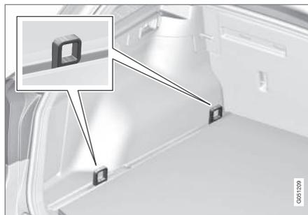
Расположение точек крепления в грузовом отсеке (с фиксированными проушинами для крепления груза).
