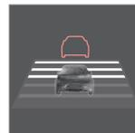
Вы можете выбрать разный временной интервал до автомобиля впереди вас, который отображается в комбинированном приборе в виде 1-5 горизонтальных штрихов – чем
