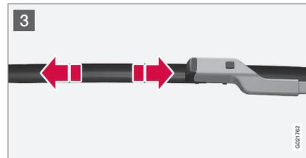
1. Поднимите рычаг стеклоочистителя, когда он находится в сервисном положении. Нажмите кнопку, расположенную на креплении щетки и вытяните параллельно рычагу стеклоочистителя.
