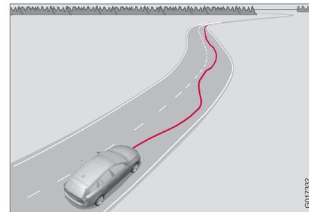
Камера считывает разметку дорожной полосы и сравнивает протяжение дороги с поворотами рулевого колеса. Водителю подается сигнал тревоги, если автомобиль не следует плавно за поворотами дороги.
