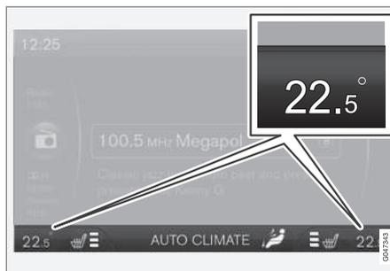
На дисплее центральной консоли отражаются значения температуры для каждой стороны.
