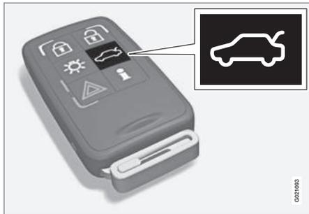
С помощью кнопки
