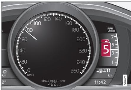
Комбинированный прибор "Digital" с индикатором переключения передач.
