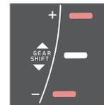
Индикатор переключения передач для механической коробки передач. В каждый момент времени горит только один указатель – при движении в обычном режиме горит только указатель в центре.
