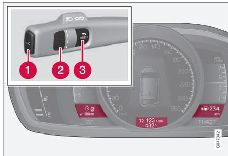
Три рубрики бортового компьютера могут показываться одновременно – по одной в каждом "окне".
