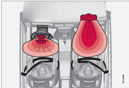
Система подушек безопасности установлена сверху, автомобиль с левосторонним управлением.
