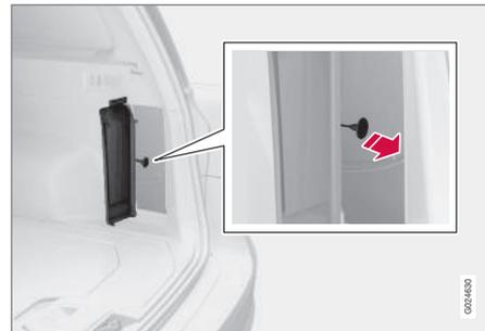
1. Откройте/снимите боковой лючок в грузовом отсеке (на той же стороне, что и крышка топливного бака) и достаньте тросик зеленого цвета с ручкой.
