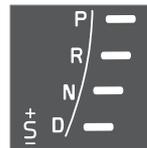
Положения передач в автоматическом режиме показываются в комбинированном приборе с правой стороны. (В каждый момент времени горит только один указатель - для действующего положения селектора передач.)
