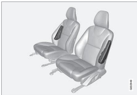
Система SIPS-bag состоит из двух основных частей: боковой подушки безопасности и датчиков. Боковая подушка безопасности смонтирована на раме спинки переднего кресла.
