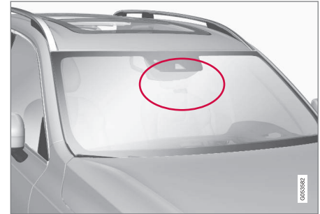
Umiejscowienie modułu radarowego.
