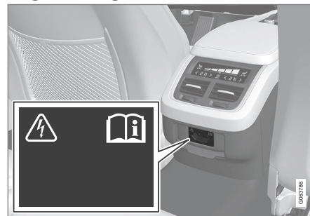
Eluttag i tunnelkonsol, baksäte.
