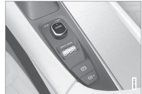
Startvredet i tunnelkonsolen.
