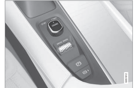
Startvredet i tunnelkonsolen.
