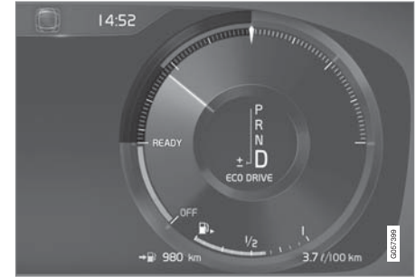
مقياس Eco في شاشة السائق قياس ١٢ بوصة.*
