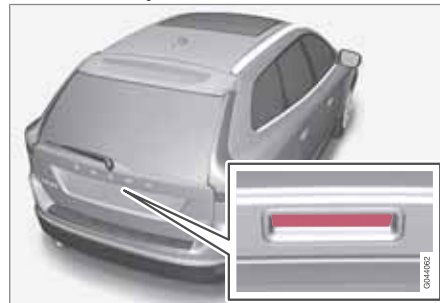
Pokryty gumą przycisk ze stykiem elektrycznym.
