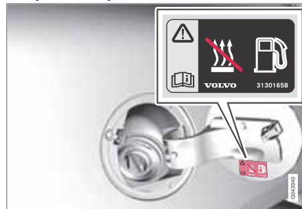
Etykieta ostrzegawcza na pokrywie wlewu paliwa.
