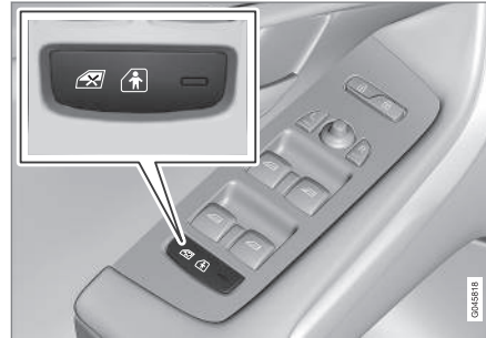
A vezetőajtó vezérlőpanelje.
