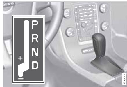
**D:** polohy automatického řazení. **+/-:** polohy manuálního řazení.
