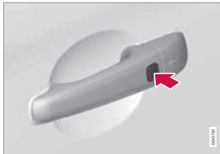
Vozidla se systémem keyless drive mají tlačítka na vnějších klíkách dveří.
