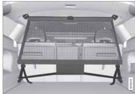
Bezpečnostní síť je upevněna ve čtyřech upevněvacích bodech.
