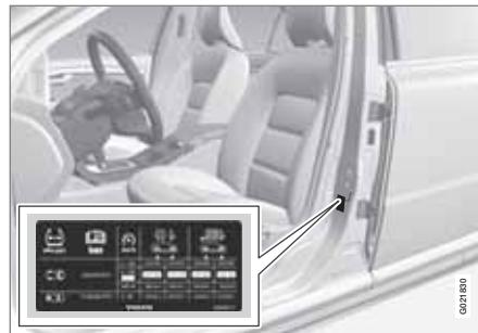
Na štítku s tlaky vzduchu v pneumatikách na sloupek dveří řidiče (mezi rámem a zadními dveřmi) jsou uvedeny tlaky vzduchu v pneumatikách pro různá zatížení a rychlosti. Tyto hodnoty najdete také dále v tabulce s tlaky vzduchu v pneumatikách, viz strana 389.
