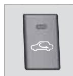
Pokud je recirkulace zapnuta, svítí oranžová kontrolka v tlačítku. Tato funkce může být použita, když chcete zabránit nasávání znečistěného vzduchu zvenku, např. výfukových plynů do prostoru pro cestující. Je-li zapnuta tato funkce, vzduch v prostoru pro cestující je recirkulován, do vozu není nasáván žádny vzduch zvenku.
