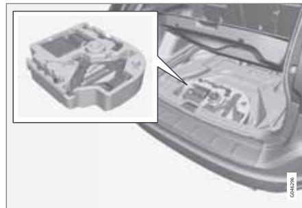
Sada pro rychlou opravu pneumatik (TMK, Temporary Mobility Kit) se používá k utěsnění defektu a ke kontrole a úpravě tlaku vzduchu v pneumaticce. Obsahuje kompresor a nádobku s těsnicím prostředkem. Sada je určena pro provedení dočasné nouzové opravy. Nádobka s těsnicí kapalinou musí být vyměněna před uplynutím data použitelnosti a po použití.
