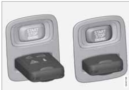
Spínač zapalování s vytaženým/vloženým dálkovým ovladačem.
