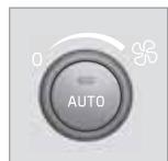
Rychlosť ventilátoru můžete snížit nebo zvýšit otáčením knoflíku. Pokud je zvolena funkce **AUTO**, rychlosť ventilátoru je řízena automaticky. Předtím nastavená rychlosť je změněna.
