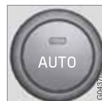
Funkce Auto reguluje automaticky teplotu, klimatizaci, rychlosť ventilátoru, recirkulaci a distribuci vzduchu.
