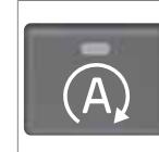
V některých situacích může být vhodné dočasně vypnout automatickou funkci Start/Stop jedním stisknutím tohoto tlačítka - přitom kontrolka na tlačítku zhasne.
