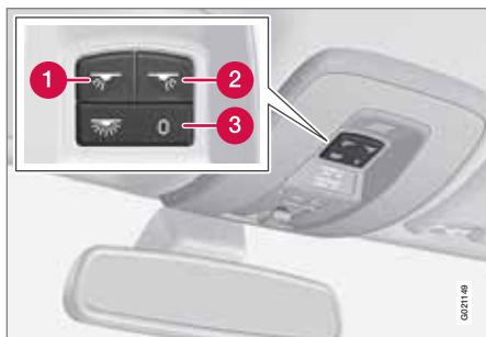
Ovládací prvky ve stropní konzole pro přední lampičky na čtení a osvětlení prostoru pro cestující.
