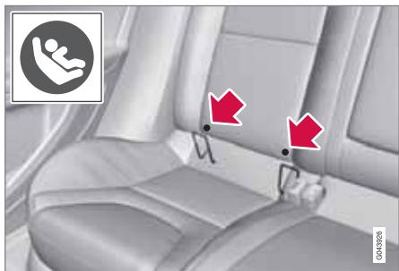
Montážní body pro systém upevnění ISOFIX jsou ukryti za dolní části opěradla vnějších zadních sedadel.
