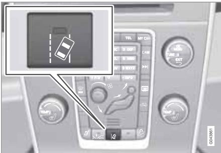
Funkce se zapíná a vypíná spínačem na středové konzole. Kontrolka v tlačítku svítí, když je funkce zapnuta.
