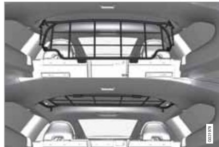
Bezpečnostní mříž brání vymrštění nákladu nebo přepravovaného zvířete dopředu do prostoru pro cestující v případě prudkého brzdění.
