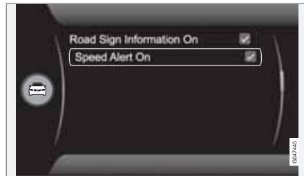
Řidič si může nastavit aktivaci varování v případě, kdy platný limit rychlosti bude překročen o více než 5 km/h. Toto varování poznáte podle toho, že symbol platné maximální rychlosti bude blikat po celou dobu, kdy je rychlosť překračována.
