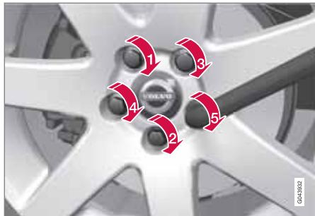
4. Utáhněte šrouby kola křížovým způsobem. Je důležité, aby šrouby kola byly správně utaženy. Utáhněte na moment 140 Nm. Zkontrolujte utahovací moment momentovým klíčem.
