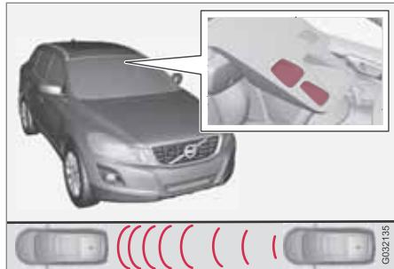
Vysílač a přijímač laserového senzoru v čelním okně<sup>1</sup>.
