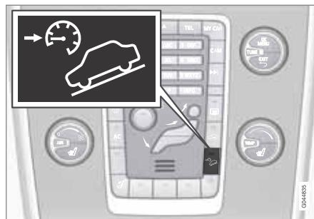
HDC se zapíná nebo vypíná spínačem na středové konzole. Kontrolka v tlačítku svítí, když je funkce zapnuta. V průběhu činnosti
