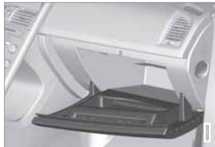
Sem můžete uložit například příručku pro uživatele a mapy. Na vnitřní straně víka jsou také držáky pro pera. Schránku v přístrojové desce lze zamknout pomocí čepele klíče, viz strana 48 a 55.
