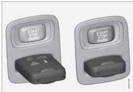
Spínací skříňka s vytaženým/zasunutým dálkovým ovladačem s klíčem a tlačítka **START/STOP ENGINE**.
