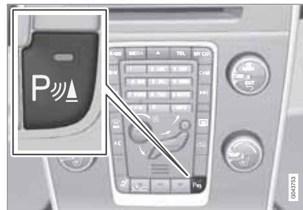
Systém se automaticky aktivuje při nastartování motoru - rozsvítí se kontrola Zap/Vyp spínače. Pokud je parkovací asistent deaktivován tlačítkem, kontrolka zhasne.
