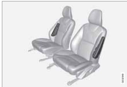
Velká část sil při nárazu z boku je přenesena prostřednictvím SIPS (Systém ochrany proti bočnímu nárazu) do podlahy, střechy, nosníků, sloupků a ostatních konstrukčních prvků karoserie. Boční airbagy řidiče a spolujezdce chrání hrudník a kyčle a jsou důležitou součástí systému SIPS.
