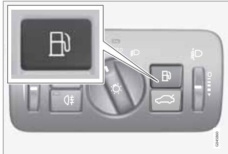
Pomocí tlačítka na panelu osvětlení otevřete dvířka hrdla palivové nádrže - po uvolnění tlačítka se dvířka otevřou.
