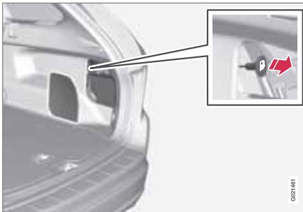
Nelze-li otevřít dvířka hrdla palivové nádrže elektricky z prostoru pro cestující, mohou být dvířka otevřena manuálně.
