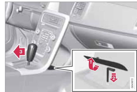
Pokud je vozidlo nepojízdné, např. z důvodu vybitého akumulátoru, musí být páka voliče přesunuta z polohy **P**, aby se s vozidlem mohlo pohybovat.
