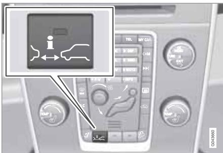
Stisknutím tlačítka ve středové konzole funkci zapnete nebo vypnete. Funkce je zapnuta, když svítí jedna kontrolka v tlačítku.
