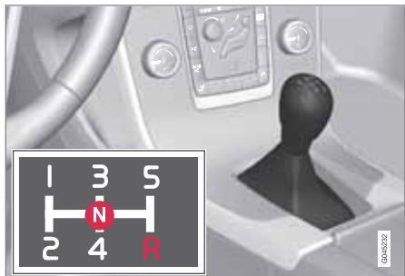
Schéma řazení u pětistupňové převodovky.
