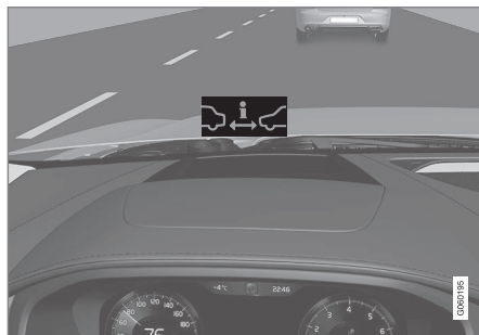
Symbole du contrôle de la distance sur pare-brise avec affichage tête haute.
