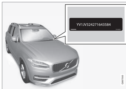
L'emplacement du VIN est identique quel que soit modèle.
