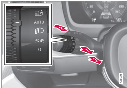
Levier au volant avec molette.
