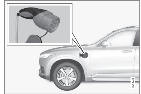
Poignée de câble de chargement et prise de chargement.
