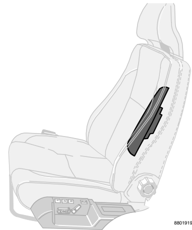
Sidokrockkuddarna är monterade i framstolarnas ryggramar
