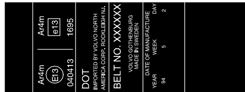
Märkning på säkerhetsbälten med bältessträckare
