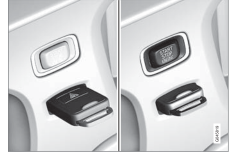
قفل الإشعاع مع مفتاح التحكم عن بعد مفرودا/مدخلا وزر START/STOP ENGINE .
