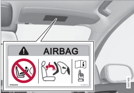
موضع الوسادة الهوائية في جانب الراكب الأمامي في السيارات ذات عجلة القيادة اليمنى.
