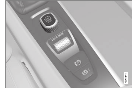
Pokrętko rozruchu na konsoli między fotelami.
