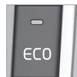
При отключении функции ECO в комбинированном приборе гаснет символ **ECO** и лампа в кнопке ECO. Функция выключена до тех пор, пока она не включается нажатием кнопки ECO.
