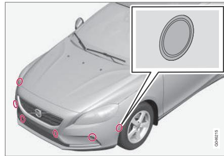
Датчики PAP расположены в бамперах<sup>37</sup>: 6 датчиков спереди и 4 датчика сзади.
