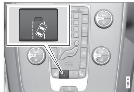
Чтобы включить или отключить функцию, нажмите кнопку на центральной консоли. Лампа в кнопке горит, когда функция включена.
