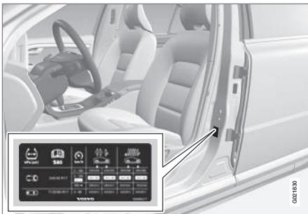
На наклейке, расположенной на дверной стойке на стороне водителя (между передней и задней дверью), указано давление в шинах при различной нагрузке и скоростях. Эта же информация приведена в таблице давления в шинах.
