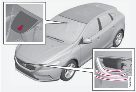
Датчик камеры или радиолокационный датчик<sup>26</sup>.
