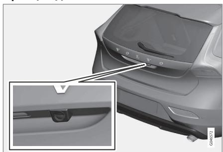
Камера установлена вблизи ручки открытия крышки.
