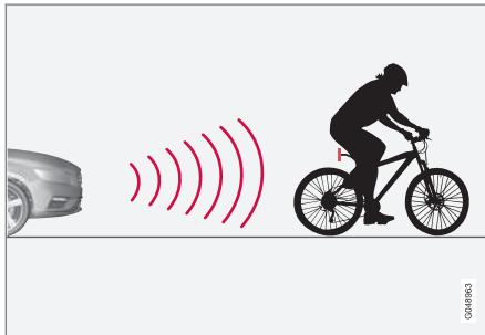
Функция "узнает" велосипедистов только сзади и в том случае, когда они двигаются в одном направлении с автомобилем.
