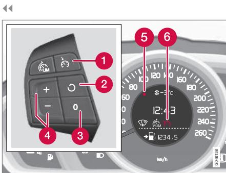
Клавиатура на рулевом колесе и дисплей в автомобиле с ограничителем скорости<sup>5</sup>.
