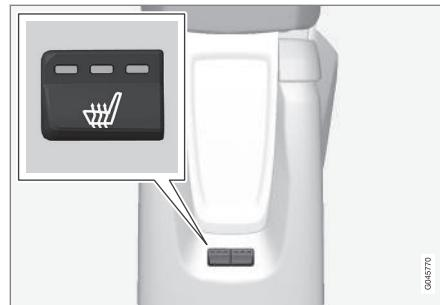
Заданный уровень обогрева отображается количеством включенных в кнопке ламп:
