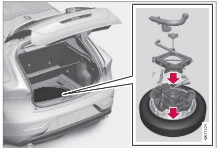
После использования инструменты и домкрат следует правильно положить на место в пенопластовый блок.
