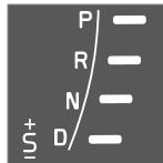
Автоматическая индикация передач – в комбинированном приборе справа (в каждый данный момент горит только один маркер – для текущего положения селектора передач).
