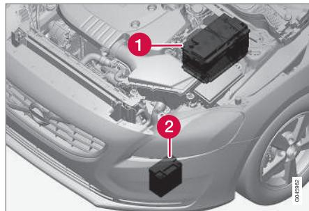
(1) Пусковой аккумулятор<sup>14</sup> (2) Вспомогательный аккумулятор
