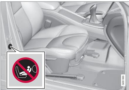
Вариант 2: Расположение наклейки для подушки безопасности на стойке двери со стороны пассажира. Наклейка видна, когда открыта дверь пассажира.
