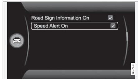
Водитель может выбрать, следует ли получать предупреждение, когда действующее ограничение скорости превышается на 5 км/ч или больше. Предупреждение о превышении скорости выдается в виде мигающего символа с указанием текущей максимальной скорости.
