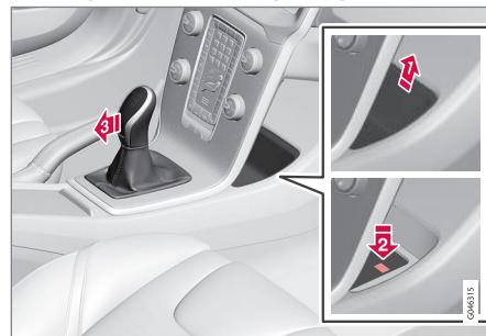
Если автомобиль находится в нерабочем состоянии, например, разряжена аккумуляторная батарея, то для перемещения автомобиля необходимо вывести селектор передач из положения **P**.
