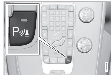
Выключатель (Вкл./Выкл.) для датчиков системы помощи при парковке и СТА (Cross Traffic Alert – Радар «заднего вида»), предупреждающего о транспорте в пересекающем направлении при движении задним ходом.<sup>30</sup>
