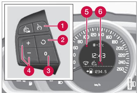
Набор кнопок на рулевом колесе и комбинированный прибор в автомобиле **с ограничителем скорости**<sup>4</sup>.
