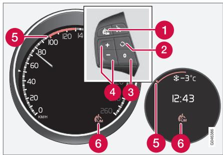
Набор кнопок на рулевом колесе и комбинированный прибор, цифровой и аналоговый соответственно.
