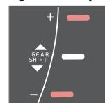
Индикатор переключения передач для механической коробки передач. В каждый данный момент времени горит только один маркер; при нормальной езде светится только тот, который
