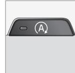
Функция Start/Stop активируется автоматически после запуска двигателя ключом. Для привлечения внимания водителя к этой функции в комбинированном приборе появляется символ кнопки Вкл./Выкл. и в кнопке Вкл./Выкл. включается лампа.
