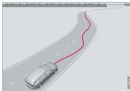
Камера считывает разметку дорожной полосы и сравнивает протяжение дороги с поворотами рулевого колеса. Водителю подается сигнал тревоги, если автомобиль не следует плавно за поворотами дороги.
