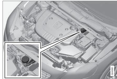
Бачок с жидкостью расположен на стороне водителя.
