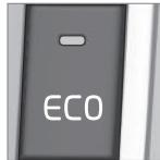
Если активирована функция ECO, двигатель может автоматически останавливаться до полной остановки автомобиля.
