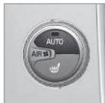
Функция Auto автоматически регулирует температуру (стр. 145), кондиционирование воздуха (стр. 146), скорость вращения вентилятора (стр. 144), рециркуляцию (стр. 147) и распределение воздуха (стр. 139).
