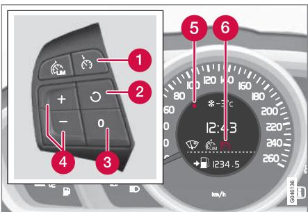
Клавиатура на рулевом колесе и дисплей в автомобиле **с ограничителем скорости**<sup>9</sup>.
