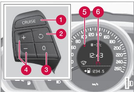
Клавиатура на рулевом колесе и дисплей в автомобиле **без ограничителя скорости**<sup>9</sup>.
