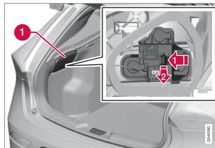
1. Снимите крышку в обивке (1) на той стороне, где перегорела лампа.
