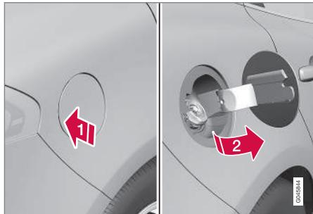
1 Откройте крышку топливного бака, надавив на ее заднюю часть.
