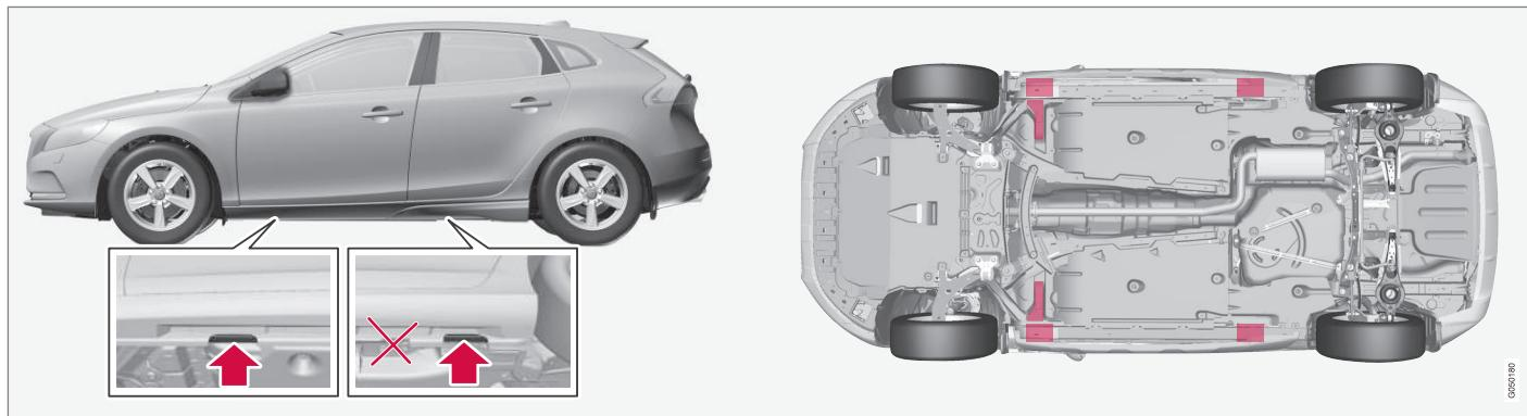
Упоры для установки домкрата, входящие в комплект автомобиля, и точки подъема (обозначены красным).
