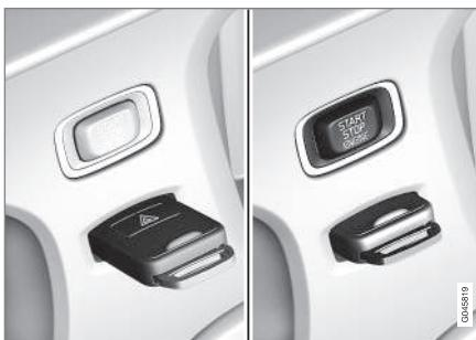
Дистанционный ключ отжат/вставлен в замок запуска и кнопка **START/STOP ENGINE**.
