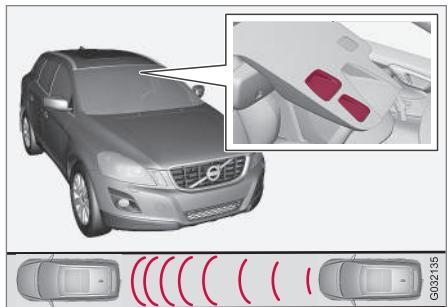
Приемно-выходное окно лазерного датчика<sup>18</sup>.
