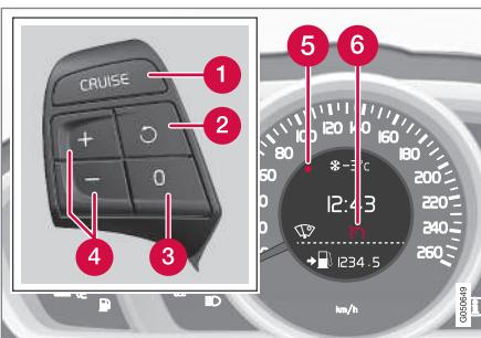
Клавиатура на рулевом колесе и дисплей в автомобиле **без** ограничителя скорости<sup>8</sup>.
