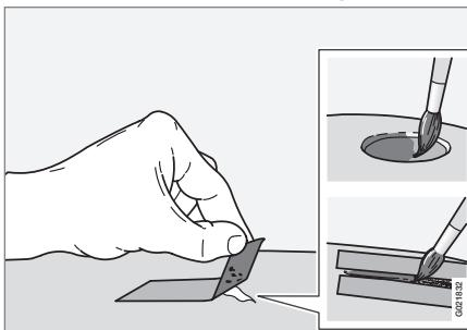
Перед началом работ по восстановлению лакокрасочного покрытия автомобиль необходимо вымыть и высушить, а его температура должна быть выше 15 °C.
