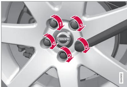
4. Затяните колесные гайки крест-накрест. Важно, чтобы колесные гайки были затянуты с правильным моментом. Проверьте момент затяжки динамометрическим ключом.
