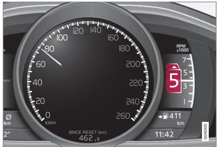
Комбинированный прибор "Digital" с индикатором переключения передач.
