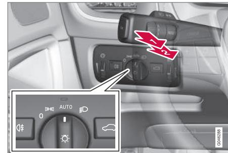
Подрулевой рычаг и ручка регулировки света.
