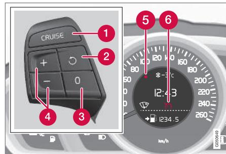
Клавиатура на рулевом колесе и дисплей в автомобиле **без ограничителя скорости**<sup>5</sup>.
