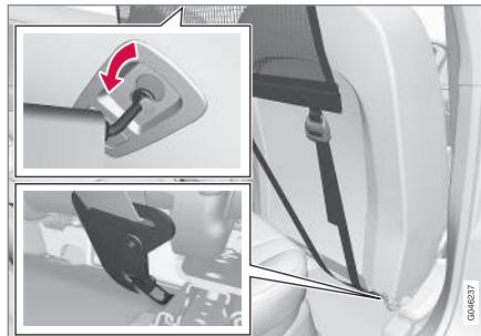
4. Закрепите анкерные стяжки для крепления груза в проушинах сзади подъезев кресел – это легче сделать, если поднять спинки кресел и передвинуть кресла немного вперед.
