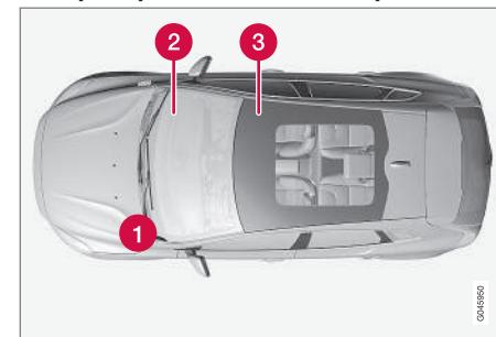
Расположение блоков предохранителей в автомобиле с левосторонним управлением. В автомобиле с правосторонним управлением блоки предохранителей под перчаточным ящиком находятся с другой стороны.
