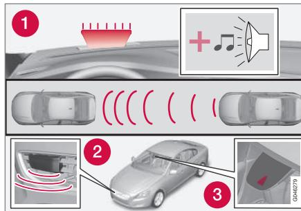
1. Индикаторная лампа и звуковой сигнал<sup>12</sup> системы предупреждения о столкновении.
