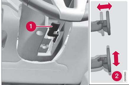
Регулировка рулевого колеса.
