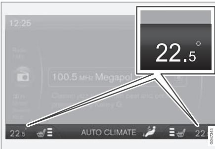
На дисплее центральной консоли отражается значение температуры для каждой стороны.
