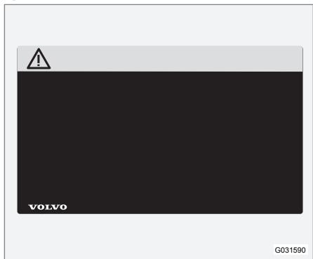
Символы ISO черного цвета на желтом фоне предупреждения, текст/рисунок белого цвета на черном поле сообщения. Используются для указания об опасности, которая в случае если предупреждение игнорируется, может приводить к опасным или смертельным травмам.
