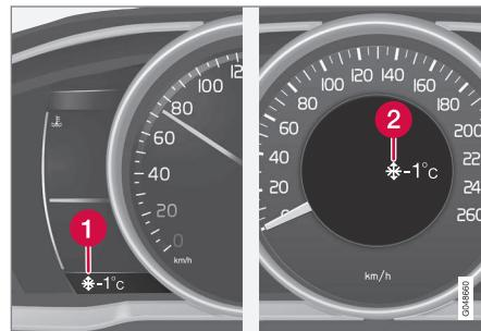
**1** Дисплей наружной температуры, цифровой прибор
