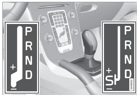
**D:** Положения при автоматическом переключении передач. **+/-:** Положения при ручном переключении передач. **S:** Режим Sport\*.<sup>4</sup>
