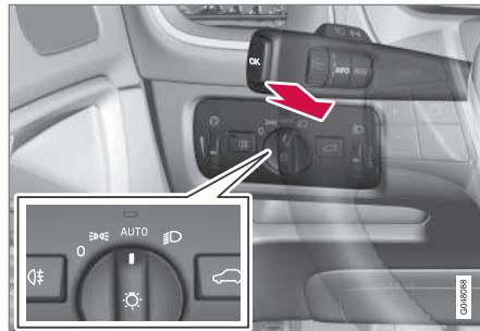
Подрулевой рычаг и ручка регулировки света в положении **AUTO**.
