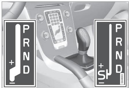
**D:** Положения при автоматическом переключении передач. **+/-:** Положения при ручном переключении передач. **S:** Режим Sport\*.<sup>6</sup>
