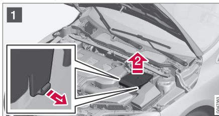
1 ➊ Отогните фиксаторы, расположенные по бокам крышки пускового аккумулятора.
