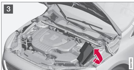
**3** Чтобы получить доступ к предохранителям, откиньте крышку в сторону двигателя.
