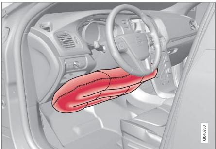
Коленная подушка безопасности на стороне водителя, автомобиль с левосторонним управлением.
