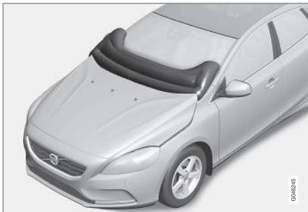
Защитная подушка для пешехода (Pedestrian Airbag) монтируется под капотом рядом с ветровым стеклом. При некоторых типах лобовых столкновений датчики в переднем бампере регистрируют столкновение с пешеходом, и подушка безопасности срабатывает, если сила столкновения оценивается достаточной силой. Датчики действуют на скорости примерно 20-50 км/ч и температуре окружающего воздуха от -20 до +70 °C.
