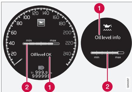
Сообщение и графическое изображение на дисплее. Слева изображен дисплей цифрового комбинированного прибора, справа – аналогового комбинированного прибора.
