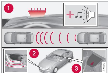
1. Акустический и визуальный предупреждающий сигнал в случае опасности столкновения.
