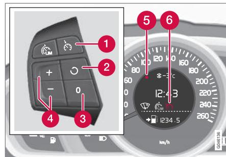
Клавиатура на рулевом колесе и дисплей в автомобиле **с** ограничителем скорости<sup>8</sup>.
