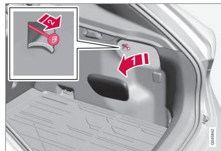
1 Откройте/снимите боковой лючок в грузовом отделении (со стороны крышки топливного бака).
