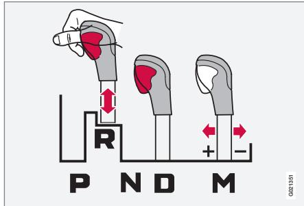
Рычаг можно свободно переводить вперед или назад между **N** и **D**. Остальные положения блокированы и управляются кнопкой блокировки на селекторе передач.
