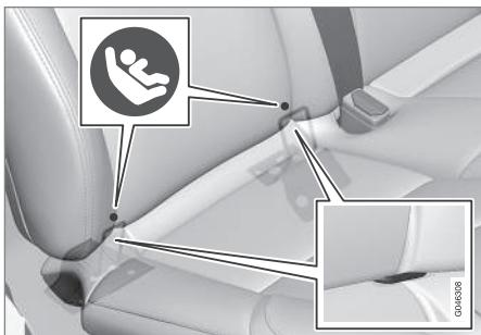
Точки крепления системы ISOFIX спрятаны сзади в нижней части спинки внешних мест заднего сиденья.
