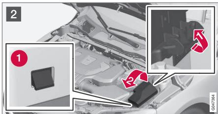
**2** Отогните фиксатор, расположенный сбоку на токораспределительной коробке.
