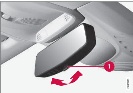
**1 Установка противоослепляющего положения**
