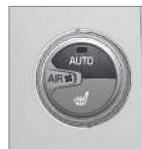
Для увеличения уменьшения скорости вентилятора поверните ручку, отсоедините **AUTO**. При выборе **AUTO** скорость вращения вентилятора регулируется автоматически (стр. 145) – ранее установленные значения скорости вращения вентилятора отключаются.
