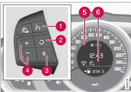
Клавиатура на рулевом колесе и дисплей в автомобиле **с** ограничителем скорости<sup>6</sup>.
