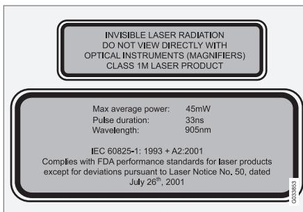
Верхняя табличка на рисунке определяет класс лазерного излучения:
