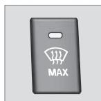
При включенном функции горит лампа в кнопке дефростера.
