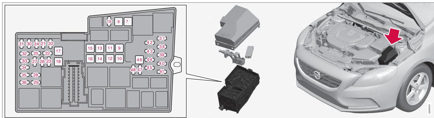
Под крышкой находятся щипцы, которые помогут вам снять и поставить на место предохранитель.
