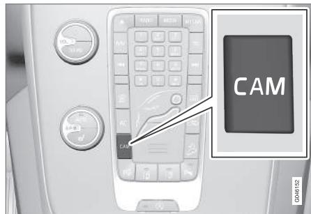
Расположение кнопки может отличаться в зависимости выбранного прочего оборудования.
