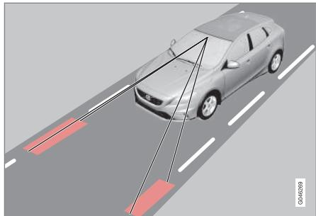
Камера считывает нанесенные боковые линии разметки дороги/полосы движения. Если автомобиль готов пересечь боковую разметку, функция предупреждения о сходе с полосы активно возвращает автомобиль в свой ряд, прикладывая незначительный крутящий момент к рулевому колесу.
