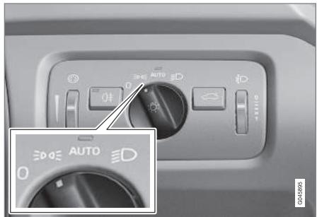
Ручка регулировки света в положении габаритных/стояночных огней.
