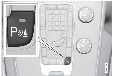
Переключатель датчиков системы помощи при парковке и СТА.
