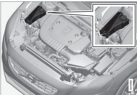
При заправке выполняйте инструкции, приведенные на упаковке. Никогда не добавляйте только чистую воду. Стойкость к замерзанию снижается, как при недостаточном, так и избыточном количестве охлаждающей жидкости в смеси.
