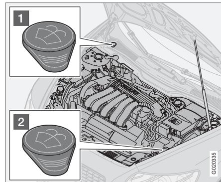
Местоположение бачка омывающей жидкости<sup>4</sup>.
