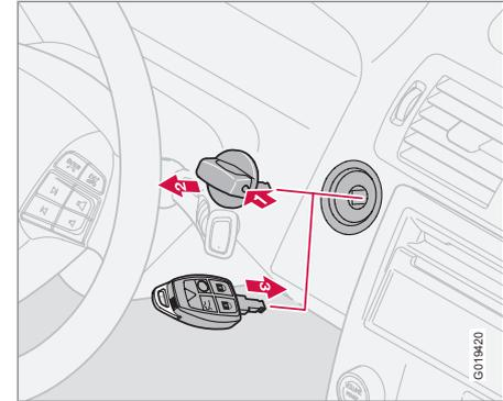
Если батарейка дистанционного ключа разряжена, функция keyless drive не работает. Пуск двигателя возможен, если использовать дистанционный ключ в качестве пусковой ручки.
