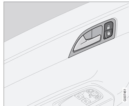
Центральной кнопкой на двери водителя вы можете одновременно запереть или отпереть двери и крышку багажника.
