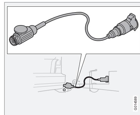
Если буксирное устройство автомобиля оборудовано 13-штекерным разъемом, а прицеп 7-штекерным разъемом, необходим специальный переходник. Используйте специальный переходник, одобренный Volvo. Проверьте, чтобы кабель не волочился по земле.
