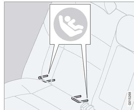
Точки крепления системы ISOFIX спрятаны сзади в нижней части спинки внешних мест заднего сиденья.
