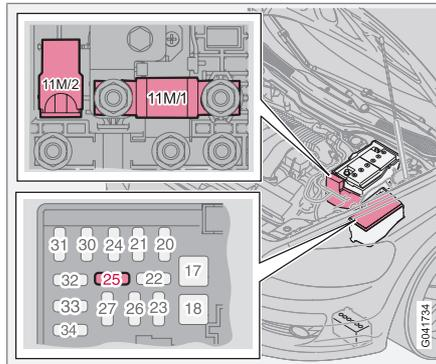
Расположение предохранителей функции Start/Stop.
