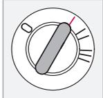
Блокировка рулевого колеса отключена. Некоторые функции можно пользоваться. Электросистема двигателя не подключена.
