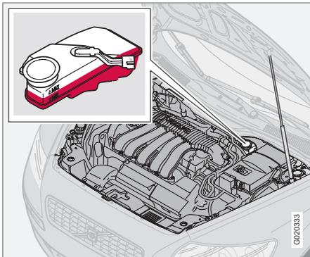
Жидкость тормозов и сцепления заливается в общий бачок<sup>5</sup>. Уровень должен лежать между отметками **MIN** и **MAX**. Регулярно проверяйте уровень. Заменяйте жидкость один раз в два года или при каждом втором плановом техобслуживании.
