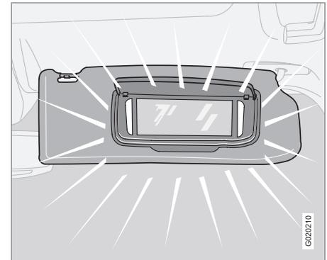
Лампа включается или выключается автоматически, когда крышка соответственно открывается или закрывается.
