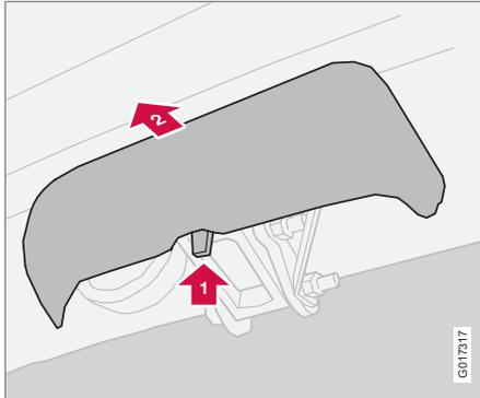
1. Снимите защитную крышку, надавив сначала на фиксатор, **1** а затем потянув крышку назад **2**.
