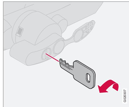
6. Поверните ключ против часовой стрелки в запорное положение. Выньте ключ из замка.
