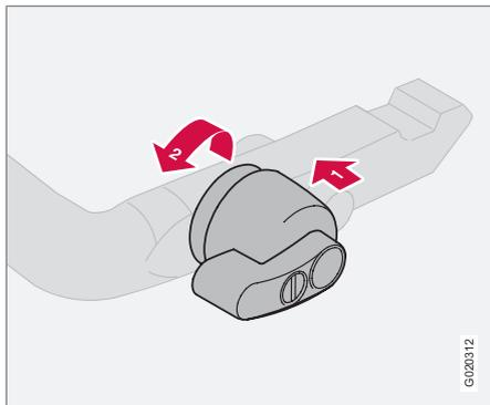
2. Нажмите стопорную ручку **1** и поверните против часовой стрелки **2** до щелчка.
