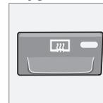
Обогрев используется для удаления обледенения и запотевания с заднего стекла и зеркал заднего вида. Если нажать один раз на кнопку, одновременно начинается обогрев заднего
