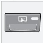
Обогрев используется для удаления обледенения и запотевания с заднего стекла и зеркал заднего вида. Если нажать один раз на кнопку, одновременно начинается обогрев заднего стекла и зеркал заднего вида. Если в кнопке горит лампа – функция активирована.
