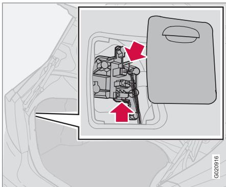
Все лампы накаливания в задней комбинации фар заменяются изнутри багажного отделения.
