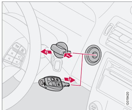
Если сигнализация не отключается дистанционным ключом, например, разряжены батарейки в ключе, автомобиль можно отпереть, снять с сигнализации и запустить двигатель следующим образом:
