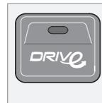
Текст на дисплее **ДВИГАТЕЛЬ В РЕЖ. АВТОСТАРТА** и зеленая лампа в кнопке напоминают и указывают на то, что двигатель находится в режиме авто-стопа.
