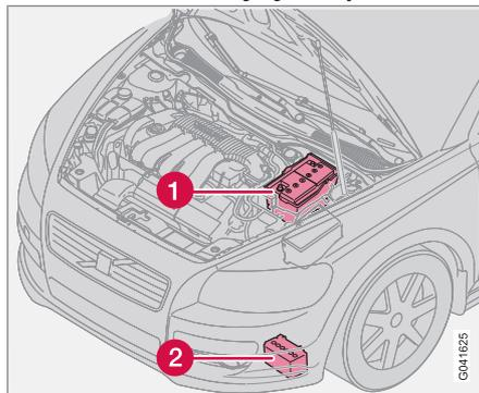
1. Пусковой аккумулятор<sup>2</sup> 2. Вспомогательный аккумулятор.
