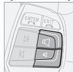
Громкость разговора регулируется при помощи кнопки на рулевом колесе.
