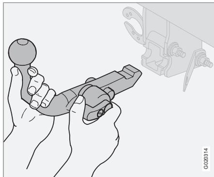
3. Поверните вниз до упора стопорную ручку и, удерживая ее, одновременно выньте буксирный крюк назад и вверх.
