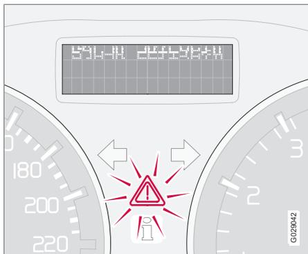
Если автомобиль участвовал в столкновении, на информационном дисплее может появиться текст **АВАРИЙН. РЕЖИМ СМ. РУКОВОДСТВО**. Это означает, что не все функции автомобиля выполняются в полном объеме. Аварийный режим – это защита, которая задействуется, когда во время столкновения могли быть повреждены важные функции автомобиля, например, топливopроводы, датчики одной из систем защиты или система тормозов.
