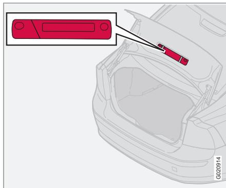
Треугольный знак аварийной остановки при помощи двух зажимов закреплен изнутри на крышке багажника.
