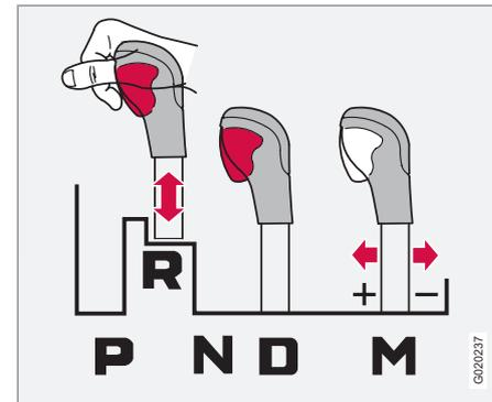
Рычаг можно свободно переводить вперед или назад между **N** и **D**. На других положениях передач установлен блокиратор, который управляется кнопкой блокировки на рычаге переключения передач.
