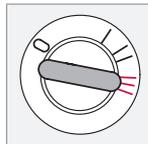
Активируется стартер. После пуска двигателя дистанционный ключ отпущается и отпружинивается назад в положение движения.
