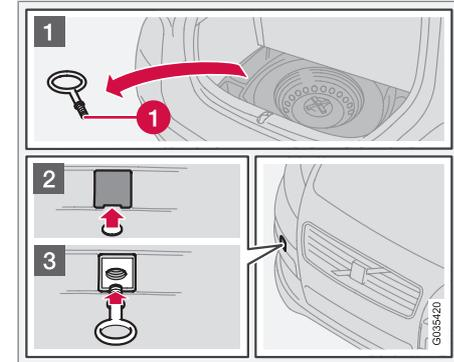
Буксировочная скоба вкручивается и закрепляется в гнезде с резьбой под защитной крышкой с правой стороны на переднем или заднем бампере.
