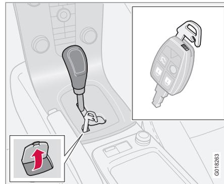
В некоторых случаях может потребоваться транспортировка неуправляемого автомобиля, например, с разряженной аккумуляторной батареей. Для транспортировки автомобиля выполните следующее:
