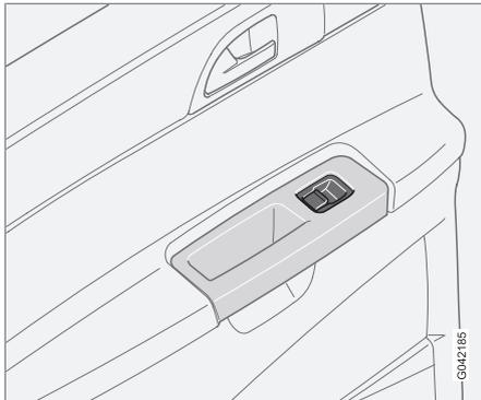
Управление стеклами задних дверей возможно клавишами соответствующих дверей или переключателем с двери водителя. Если в выключателе блокировки стеклоподъемников задних дверей (расположенном на панели управления двери водителя) горит лампа, управление стеклоподъемниками задних дверей возможно только с двери водителя. Управление стеклоподъемниками задних дверей осуществляется так же, как и передних дверей.
