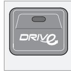
В некоторых ситуациях, если необходимо временно отключить автоматическую функцию Start/Stop, следует нажать на эту кнопку, при этом лампа в кнопке гаснет.
