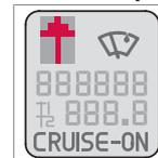
GSI – Gear Shift Indicator – сообщает водителю, когда наступает наиболее удобный момент для переключения передачи. Индикация переключения с повышением или понижением передачи выполняется в виде стрелки в нижнем информационном дисплее комбинированного прибора, см. стр. 55.
