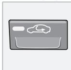
Рециркуляция не допускает проникновение в салон загрязненного воздуха, выхлопных газов и т.п. Воздух циркулирует внутри салона. Воздух снаружи не затягивается в автомобиль.
