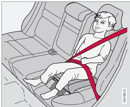
Встроенная фиксируемая ремнем подушка Volvo для внешних мест заднего сидения специально сконструирована в расчете на обеспечение оптимальной безопасности ребенка. В комбинации со штатными ремнями безопасности эти встроенные опорные подушки рассчитаны на детей весом от 15 до 36 кг.
