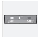
**ON:** Кондиционирование воздуха включено. Регулируется автоматикой системы. В этом случае поступающий воздух охлаждается и подсушивается.
