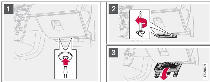
В блоке находятся 50 гнезд предохранителей. Предохранители находятся под отделением для перчаток. Там же предусмотрены гнезды для резервных предохранителей. Инструмент для замены предохранителей находится в блоке реле/предохранителей в двигательном отсеке, см. стр. 270.
