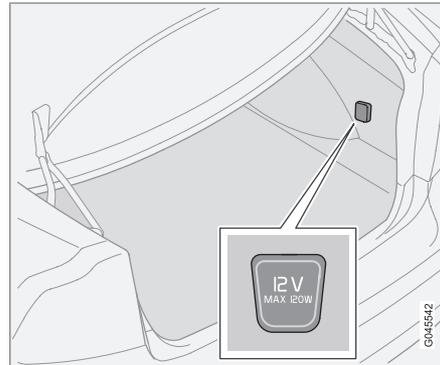
Чтобы получить доступ к электрическому гнезду, откиньте крышку. Питание на гнездо подается независимо от того, включено зажигание или нет.
