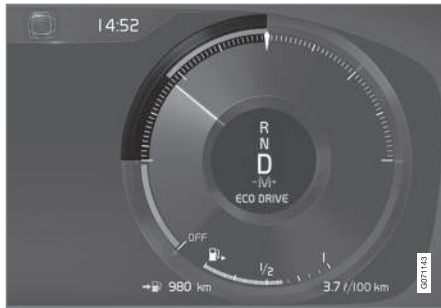
Eco műszer a 12-hüvelykes járművezetői kijelzőn*.
