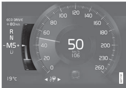
Eco műszer a 8-hüvelykes járművezetői kijelzőn.
