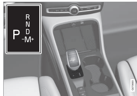
Kis sebességváltó kar és a váltási minta áttekinthetése a járművezetői kijelzőn.
