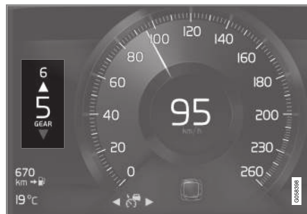
Indikátor řazení převodových stupňů na 8" displeji řidiče.
