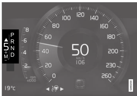
Indikátor řazení převodových stupňů na 8" displeji řidiče.
