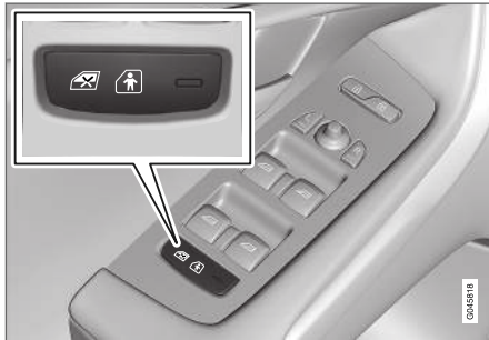
A vezetőajtó vezérlőpanelje.
