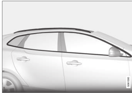
Alkatrészek, amelyek 3,5 és 11,5 pH-érték közötti tisztítószerrel moshatók.
