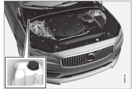
Ekspansjonsbeholder for kjølesystemet, bil med vensterratt.
