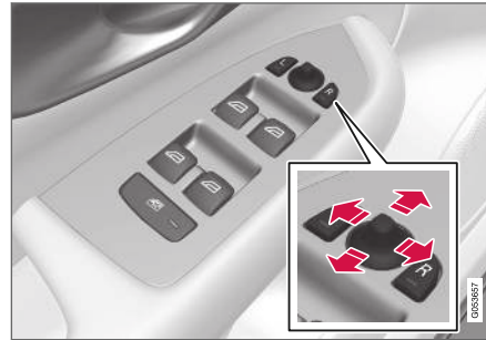
Reguleringsbryter for utvendige sidespeil.
