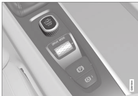
Startbryteren i tunnelkonsollen.
