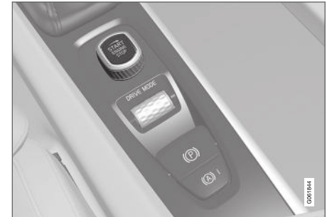
Startbryteren i tunnelkonsollen.
