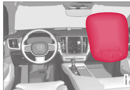
Kollisjonspute på passasjersiden i forsetet.
