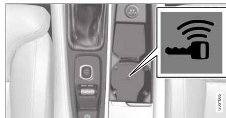
Reserveleserens plassering i tunnelkonsollen.
