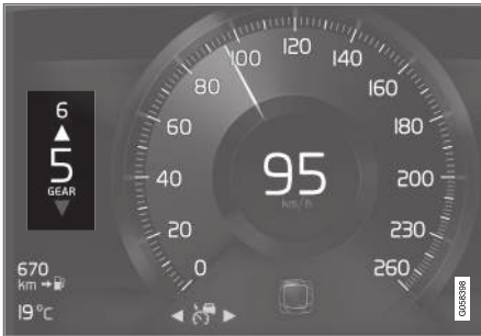
Girindikator på 8-tommers førerdisplay.
