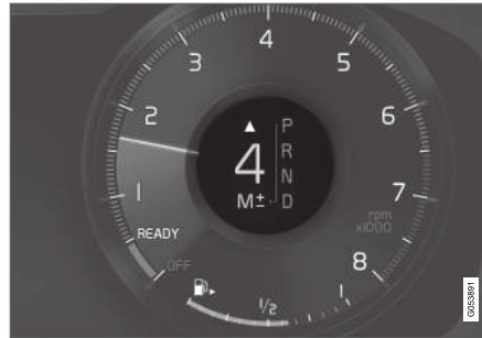
Girindikator på 12-tommers førerdisplay*.
