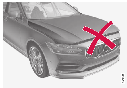
Panseret ikke helt lukket.
