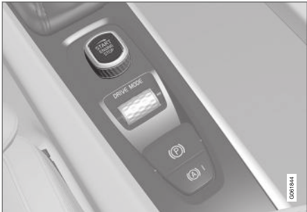
Startvredet i tunnelkonsolen.
