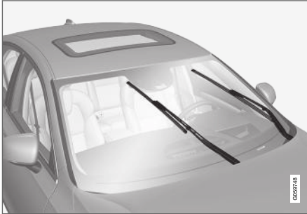
Torkarblad i serviceläge.
