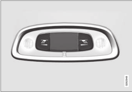
Olvasólámpák a hátsó ülés felett.
