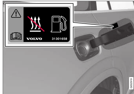
Figyelmeztető címke az üzemanyagtöltő fedélen.
