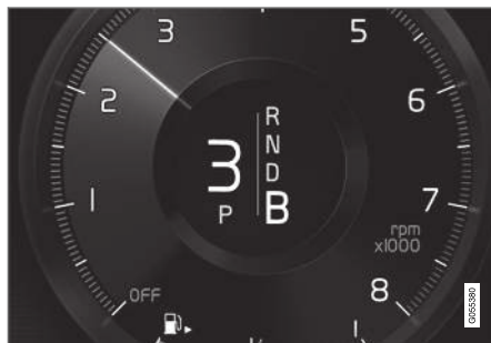
B állás a járművezetői kijelzőn.
