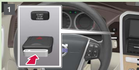
1. Introduzca la llave en la cerradura de contacto y pulse el botón hasta su posición final.
