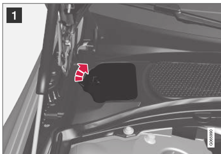
Vase d'expansion du système de refroidissement.
