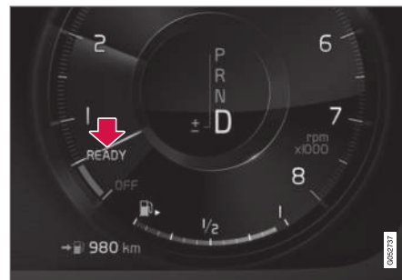
La fonction est active et le moteur est automatiquement arrêté.
