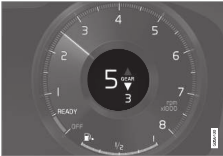
Indicateur de rapport sur l'écran conducteur 12 pouces*.
