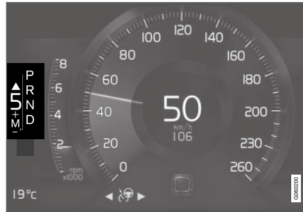
Indicateur de rapport sur l'écran conducteur 8 pouces.
