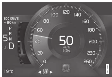
Compteur ECO sur l'écran conducteur 8 pouces.
