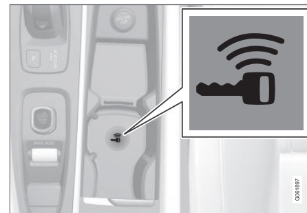
Backup-läsarens placering i tunnelkonsolen.
