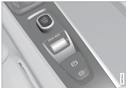
Startvredet i tunnelkonsolen.
