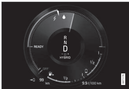
Förardisplayen vid framdrivning med både el- och förbränningsmotor.
