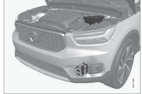
توجد بطارية الدعم قوة ١٢ فولت أسفل حجرة المحرك. كما تُعرض بطارية البادئ هنا (بالأعلى).
