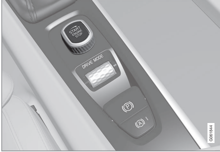
Tünel konsolundaki çalışma düğmesi.
