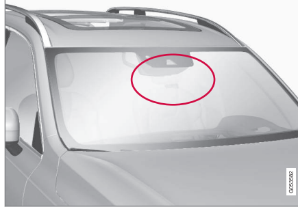
Radar ünitesi konumu
