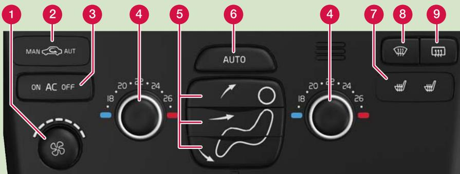
En el modo **AUTO**, el sistema ECC controla todas las funciones de manera automática, lo que facilita el manejo del automóvil con una calidad de aire óptima.
