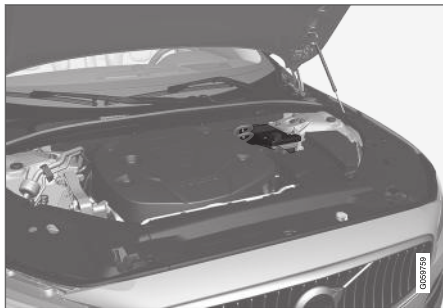
Atbalsta akumulators atrodas kastē blakus statnim.
