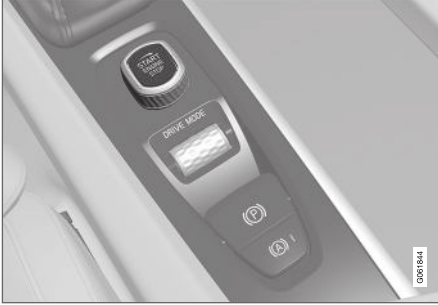
Tünel konsolundaki çalıştırma düğmesi.
