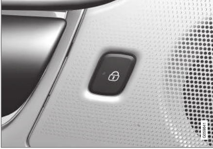
Arka kapıda gösterge lambalı kilit düğmesi.
