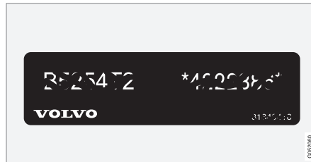
4 Autocollant pour le code moteur et le numéro de production du moteur.
