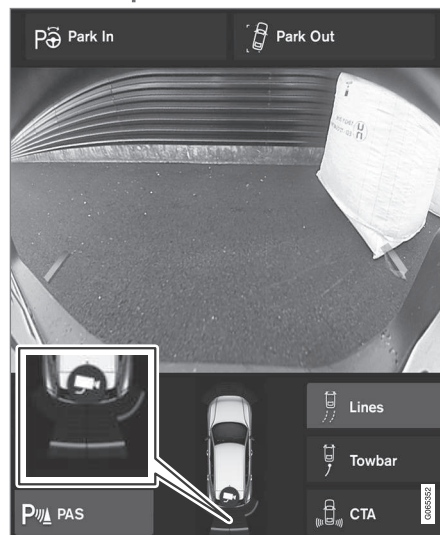
L'écran peut afficher des champs colorés de capteurs sur le symbole de voiture.
