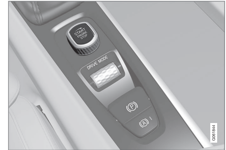
Commande de démarrage sur la console de tunnel.
