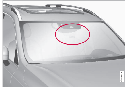
Emplacement de l'unité radar.
