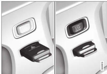
Contacteur d'allumage avec télécommande retirée/insérée et bouton START/STOP ENGINE .
