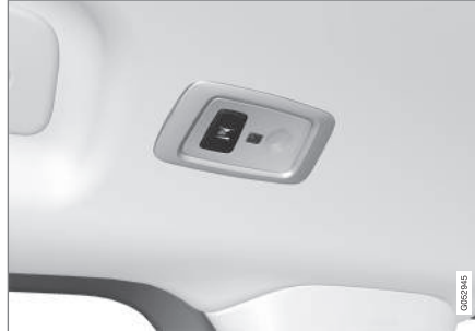
Panorama tavanı* olan araçlarda tavanın her iki tarafında birer tane olmak üzere iki lamba ünitesi vardır.
