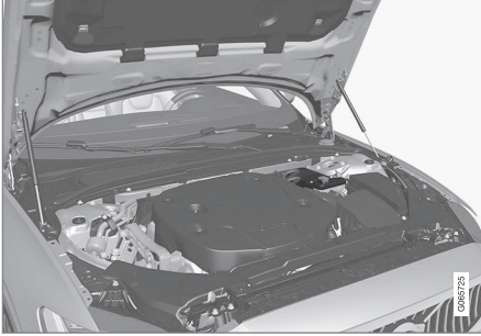
12 V destek aküsü, motor bölümünde yer alır.
