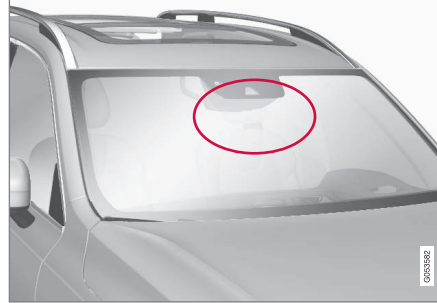
Radar ünitesi konumu
