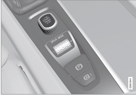
Tünel konsolundaki çalıştırma düğmesi.
