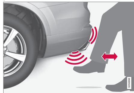
Mouvement du pied dans la zone d'activation du capteur.
