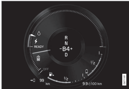
L'écran conducteur indique la charge en frein moteur électrique.
