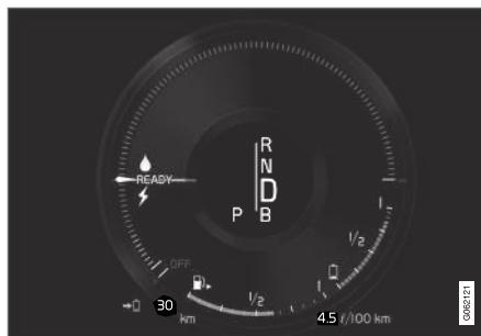
Указатель гибридной установки, используя разные средства, показывает соотношение между отбираемой от электродвигателя мощностью и доступной мощностью.
