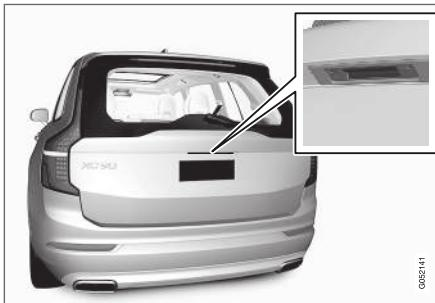
Обрезиненная нажимная пластина в двери багажника используется только для отпирания двери.
