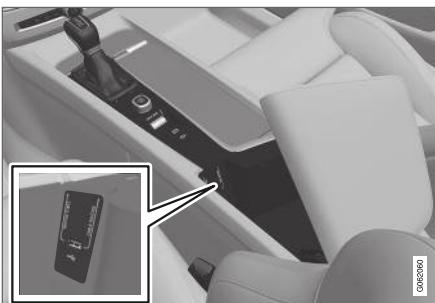
USB разъемы (тип А) в тоннельной консоли. Следите за тем, чтобы провод был направлен вперед, чтобы не защемить его при закрытии крышки.
