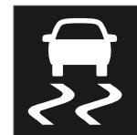
Когда стабилизатор прицепа работает, на дисплее водителя мигает символ ESC.
