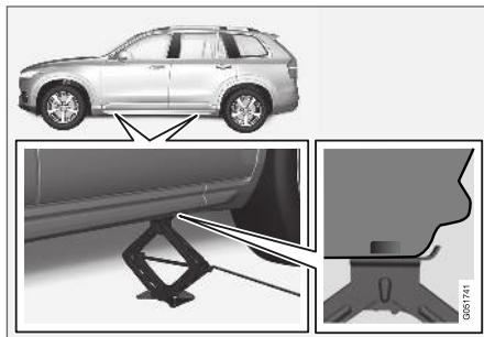
9. Установите домкрат под нужным упором на ровной, твердой и нескользкой поверхности.
