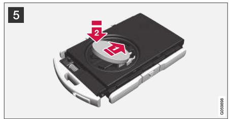
5 Установите новую батарейку стороной, обозначенной (+), вверх. Не дотрагивайтесь пальцами до контактов батарейки дистанционного ключа.
