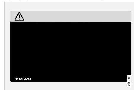
Символы ISO черного цвета на желтом фоне предупреждения, текст/рисунок белого цвета на черном поле сообщения. Используются для указания об опасности, которая в случае, если предупреждение игнорируется, может приводить к опасным или смертельным травмам.
