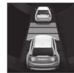
Вы можете выбрать различный временной интервал до автомобиля впереди вас, который отображается на дисплее водителя в виде 1-5 горизонтальных штрихов – чем больше штрихов, тем больше временной интервал. Один штрих соответствует прим. 1 секунде до автомобиля перед вами, 5 штрихов соответствуют прим. 3 секундам.
