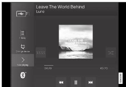
Управление медиапроигрывателем осуществляется с центрального дисплея, но некоторыми функциями можно управлять с помощью правого набора кнопок на рулевом колесе или голосовых команд.
