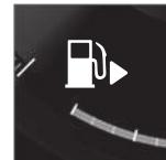
Стрелка рядом с символом топливного бака на дисплее водителя показывает, с какой стороны автомобиля расположена крышка топливного бака.
