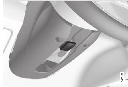
Рычаг для регулировки положения рулевого колеса.
