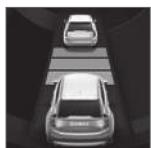
ACC контролирует время отставания от двигающегося впереди автомобиля, только когда на символе отображаются два транспортных средства.
