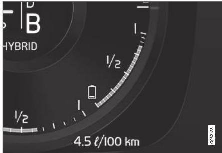
Эта энергия гибридного аккумулятора предназначена для электродвигателя, а также для охлаждения или обогрева автомобиля. Бортовой компьютер рассчитывает примерное расстояние, которое можно пройти на энергозапасе, оставшемся в гибридном аккумуляторе.
