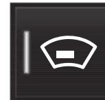
Нажмите кнопку **Проекционный дисплей** на панели функций центрального дисплея. Функция активирована, когда индикатор в кнопке горит.
