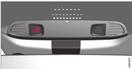
Кнопка **SOS** горит мигающим красным цветом с различной частотой в случае, если система передает данные или установила канал голосовой связи с центром обслуживания. Кнопка **SOS** горит немигающим красным цветом в случае, если система неисправна.
