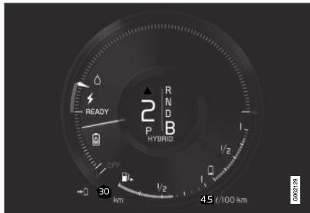
Дисплей водителя показывает, что во время действия электрического моторного тормоза заряжается аккумулятор.
