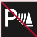
При появлении этого символа будьте особенно внимательны при движении задним ходом, если на автомобиле установлен прицеп, держатель для велосипедов или другое оборудование, присоединенное к электросистеме автомобиля.
