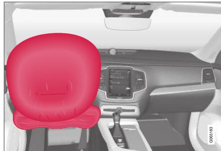
Подушка безопасности в рулевом колесе и подушка безопасности для защиты коленей для переднего сиденья на стороне водителя.
