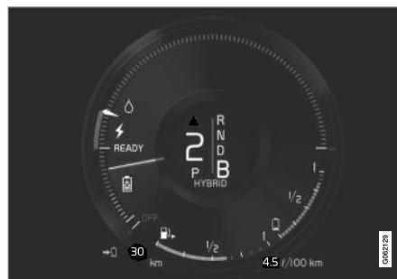
Автомобиль вырабатывает энергию для аккумулятора, аккумулятор заряжается, например, когда плавно выжимается педаль тормоза, или во время торможения двигателем на спуске.
