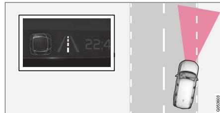
Поддержка управлением/предупреждение – линии боковой разметки на символе ОКРАШЕНЫ.
