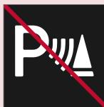
При появлении этого символа будьте особенно внимательны при движении задним ходом, если на автомобиле установлен прицеп, держатель для велосипедов или другое оборудование, присоединенное к электросистеме автомобиля.
