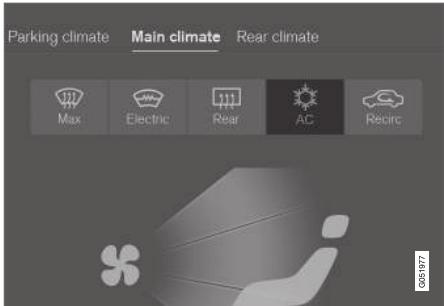
Кнопка регулировки кондиционированием воздуха на панели климат-контроля.
