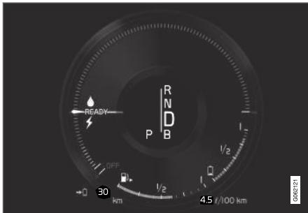
Двигатель работает, но автомобиль не движется, запрос мощности отсутствует.
