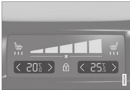
Органы управления температурой на панели климата сзади на тоннельной консоли.
