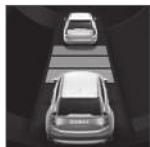
Вы можете выбрать различный временной интервал до автомобиля впереди вас, который отображается на дисплее водителя в виде 1-5 горизонтальных штрихов – чем больше штрихов,
