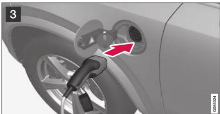
3 Откройте лючок гнезда зарядки и снимите крышку с гнезда зарядки. Снимите с насадки зарядного кабеля защитную крышку и до упора вставьте насадку в гнездо автомобиля.
