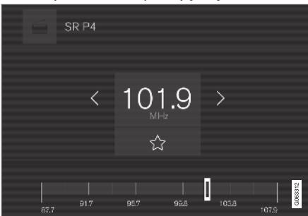
При переходе на ручной поиск радиостанций радио теперь не изменяет частоту автоматически в случае слабого сигнала.
