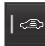
Нажмите кнопку **Частичная охрана** на панели функций центрального дисплея, чтобы отключить датчики движения и крена, когда автомобиль будет запираться в следующий раз.
