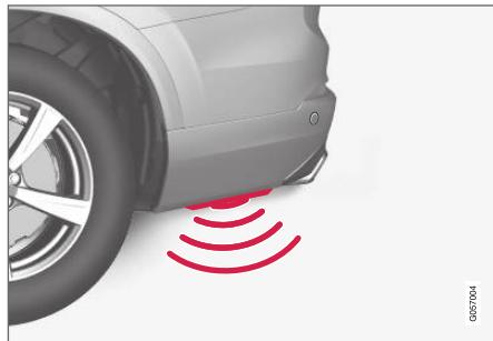
Чтобы активировать открытие или закрытие багажника движением ноги на автомобиле с накладкой на бампер, мах ногой следует совершить, находясь сбоку от автомобиля. Открыть и закрыть багажник можно только в том случае, когда один из дистанционных
