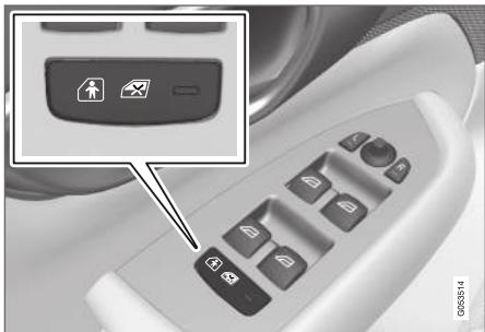
Кнопка для активирования и отключения электрической блокировки.
