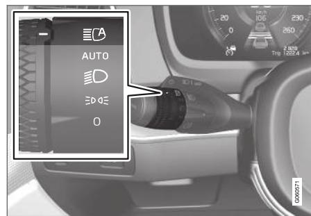
Автоматический дальний свет активируется поворотным кольцом на подрулевом рычаге в режиме AUTO .
