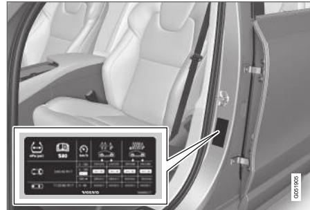
На этой табличке указаны обозначения, предельные нагрузки и давление для шин, установленных на заводе.
