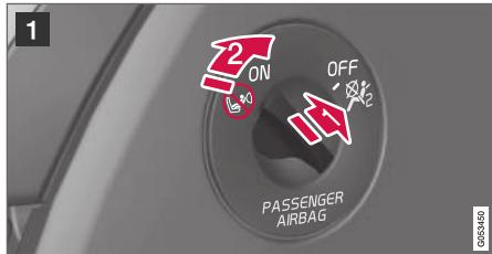
1 Потяните переключатель на себя и поверните из положения **ON** (A) в положение **OFF** (B).
