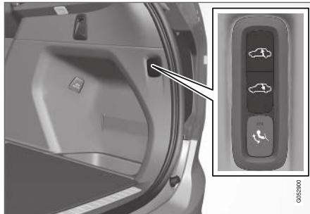
Используйте кнопки в багажном отделении для регулировки высоты задней части автомобиля и удобства погрузки и выгрузки или, когда к автомобилю присоединяется прицеп.
