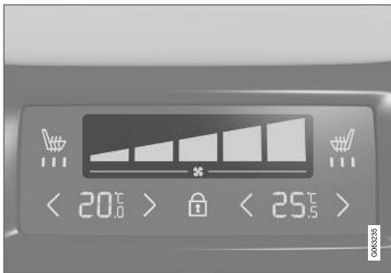
Органы управления вентилятором на панели климат-контроля сиденья на тоннельной консоли.
