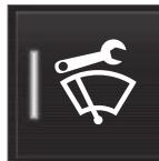
Нажмите кнопку **Серв. полож. стеклоочист.** Световой индикатор в кнопке горит, когда активировано сервисное положение. При активировании очистители перемещаются вверх и устанавливаются в вертикальном положении. Нажмите еще один раз на **Серв. полож. стеклоочист.**, чтобы отключить сервисное положение. Световой индикатор в кнопке гаснет, когда сервисное положение отключено.
