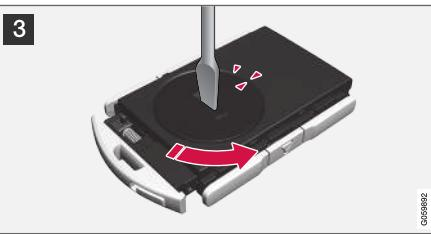
3 С помощью, например, отвертки поверните крышку батарейки против часовой стрелки, чтобы совместить маркировки с текстом **OPEN**.
