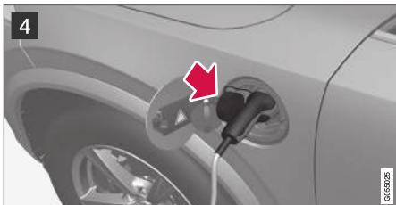
4 Закрепите защитную крышку зарядной насадки, как показано на рисунке.
