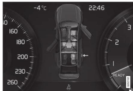
Графическое представление на дисплее водителя различных типов предупреждений. Цвет предупреждения для двери и крышки багажника зависит от скорости автомобиля.
