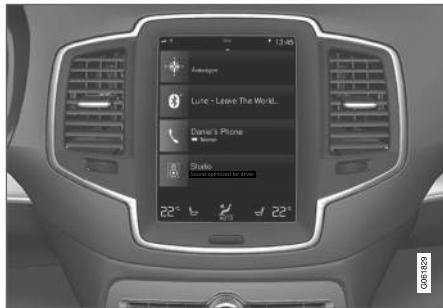
Управление многими функциями автомобиля осуществляется с центрального дисплея – сенсорного экрана, реагирующего на прикосновения, и поэтому в автомобиле установлено минимальное количество физических кнопок и ручек управления. Вы можете работать с экраном в перчатках и без них.
