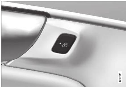
Кнопка замка с индикаторной лампой в задней двери.
