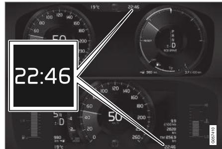
Расположение часов на дисплее водителя 12 и 8 дюймов.
