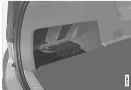
Пусковой аккумулятор находится в грузовом отсеке.
