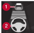
Поддержка управлением Pilot Assist действует только, когда цвет символа рулевого колеса (2) изменен с СЕРОГО на ЗЕЛЕНЫЙ.
