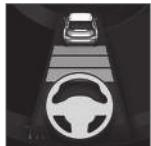
Вы можете выбрать различный временной интервал до автомобиля впереди вас, который отображается на дисплее водителя в виде 1-5 горизонтальных штрихов – чем больше штрихов, тем больше временной интервал. Один штрих соответствует прим. 1 секунде до автомобиля перед вами, 5 штрихов соответствуют прим. 3 секундам.
