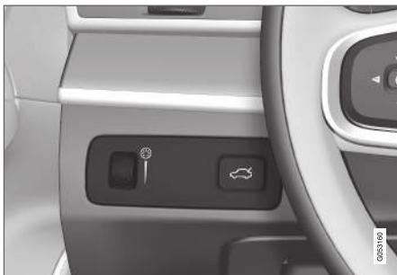
Регулировочное колесико (слева) для регулировки яркости освещения салона.
