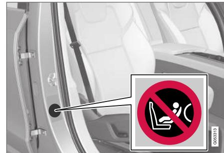
Табличка на дверной стойке со стороны пассажира. Наклейка видна, когда открыта дверь пассажира.
