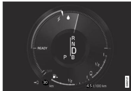
Электродвигатель не может подавать запрашиваемую мощность, и поэтому запускается двигатель внутреннего сгорания.
