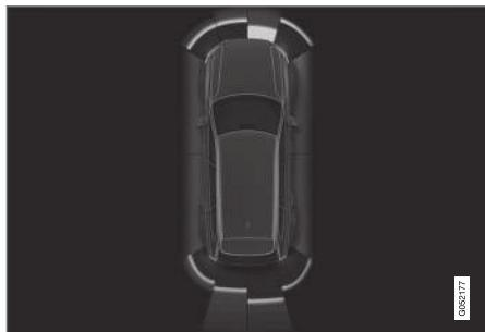
Изображение на экране с зонами препятствий и секторами действия датчиков.
