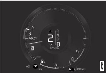
Автомобиль вырабатывает энергию для аккумулятора, и аккумулятор заряжается, например, при легком нажатии на педаль тормоза или во время торможения двигателем на спуске.
