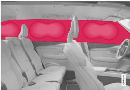
Надувной занавес смонтирован в облицовке потолка вдоль боковин автомобиля с двух сторон и помогает защитить водителя и пассажиров на внешних местах. Такие панели имеют обозначение **IC AIRBAG**.
