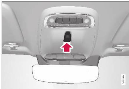
Панорамная крыша и солнцезащитная шторка приводятся в действие регулятором, расположенным в крыше.
