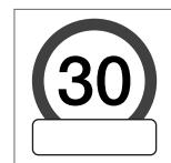
Символ дополнительной таблички в виде пустой рамки под обозначением скорости<sup>101</sup> на дисплее водителя означает, что система RSI обнаружила для данного ограничения скорости табличку с дополнительной информацией.
