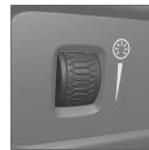
С помощью регулировочного колесика на приборной панели рядом с рулевым колесом выбирается яркость подсветки дисплеев и органов управления, рассеянного и тонального\* освещения.
