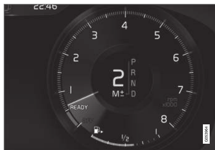
Écran conducteur lors du changement de vitesse avec palettes au volant en mode manuel de changement.
