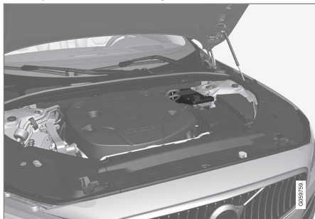
12 V atbalsta akumulators atrodas kastē blakus statnim.
