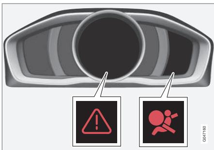
Треугольный знак аварийной остановки и предупреждающих символ для системы подушек безопасности в цифровом комбинированном приборе.
