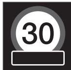
Символ дополнительной таблички в виде пустой рамки под символом скорости в комбинированном приборе означает, что система RSI обнаружила для данного ограничения скорости табличку с дополнительной информацией.
