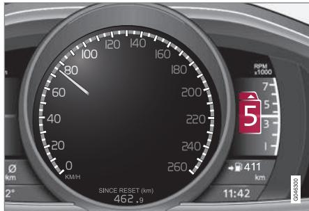
Комбинированный прибор "Digital" с индикатором переключения передач.
