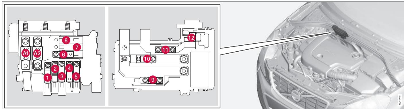
Расположение предохранителей в холодной зоне двигателя отсека.
