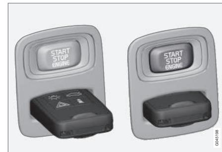
Замок запуска с выдвинутым/вставленным ключом зажигания.
