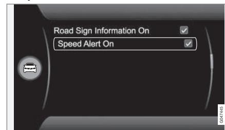
Водитель может выбрать, следует ли получать предупреждение, когда действующее ограничение скорости превышается на 5 км/ч или больше. Предупреждение о превышении скорости выдается в виде мигающего символа с указанием текущей максимальной скорости. Функцию можно активировать/отключить в системе меню **MY CAR**. Описание системы меню - см. **MY CAR** (стр. 118).
