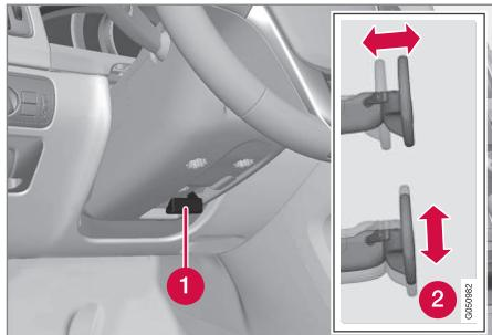
Регулировка рулевого колеса.
