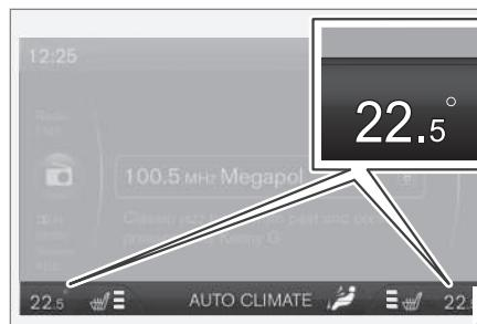
На дисплее центральной консоли отражаются значения температуры для каждой стороны.
