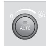
Для увеличения уменьшения скорости вентилятора поверните ручку. При выборе **AUTO** скорость вращения вентилятора регулируется автоматически (стр. 140) - ранее установленные значения скорости вращения вентилятора отключаются.
