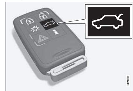
С помощью кнопки дистанционного ключа вы можете снять с сигнализации\* и отпереть только крышку багажника.
