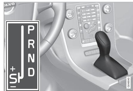
**D:** Положения передач в автоматическом режиме. **+/-:** Положения передач в ручном режиме. **S:** Режим Sport\*.
