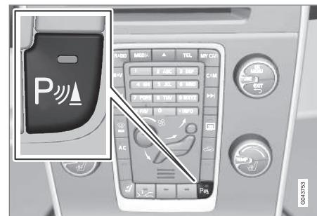
Вкл./Выкл. датчиков системы помощи при парковке и СТА.
