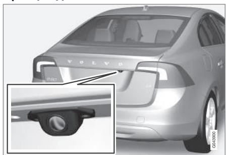
Камера установлена вблизи ручки открытия крышки.
