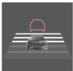
Вы можете выбрать различный временной интервал до автомобиля впереди вас, который отображается в комбинированном приборе в виде 1-5 горизонтальных штрихов – чем больше штрихов, тем больше временной интервал. Один штрих соответствует прим. 1 секунде до автомобиля перед вами, 5 штрихов – прим. 3 секундам.
