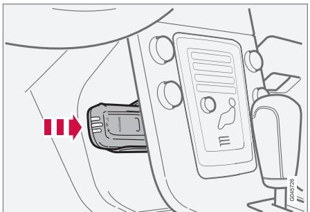
Хранение телефонной трубки и зарядного устройства.
