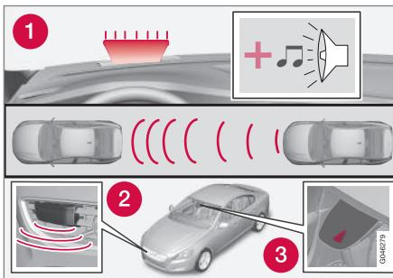
1. Индикаторная лампа и звуковой сигнал системы предупреждения о столкновении<sup>8</sup>.
