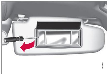
1. Вставьте отвертку под край плафона лампы и осторожно отогните вверх выступ.
