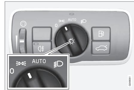
Ручка регулировки света в положении для габаритных/стояночных огней.
