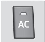
Когда в клавише **AC** горит лампа, кондиционирование воздуха работает в автоматическом режиме.
