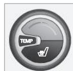
Этой ручкой устанавливается температура – отдельно на стороне водителя и пассажира.
