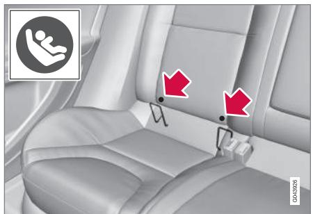
Точки крепления системы ISOFIX спрятаны сзади в нижней части спинки внешних мест заднего сидения.
