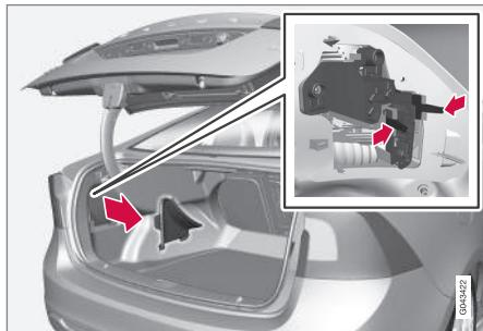
Лампы в задней комби-фаре заменяются изнутри багажного отделения (за исключением светодиодов).
