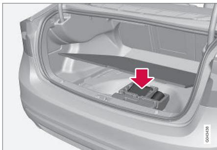
Под люком в полу грузового отсека находится буксировочная скоба, домкрат\* и баллонный ключ\*. Здесь также находятся втулка для колесных гаек и инструмент для пластиковых колпачков колесных гаек.
