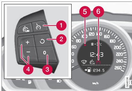
Набор кнопок на рулевом колесе и комбинированный прибор в автомобиле **с** ограничителем скорости<sup>4</sup>.
