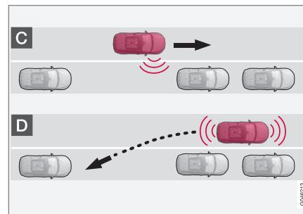
При операции "задний ход" PAP направляет автомобиль в парковочное пространство. Выполните следующие действия:
