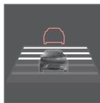
Вы можете выбрать различный временной интервал до автомобиля впереди вас, который отображается в комбинированном приборе в виде 1-5 горизонтальных штрихов – чем
