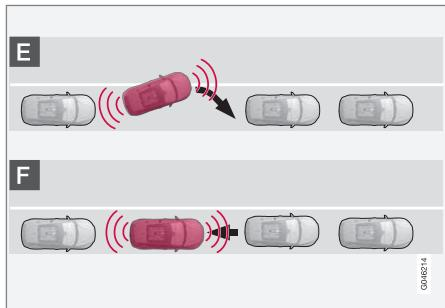
После того как автомобиль вошел в пространство парковки, он должен быть выровнен и зафиксирован.
