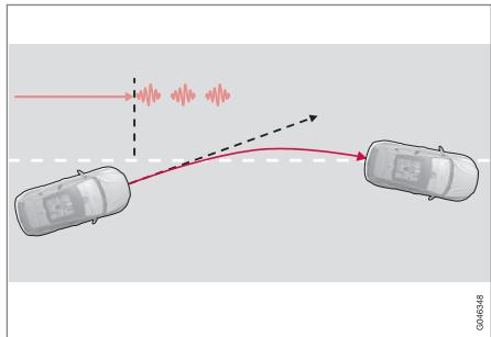
LKA выруливает и предупреждает водителя вибрацией рулевого колеса<sup>26</sup>.
