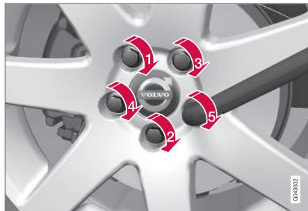
4. Затяните колесные болты крест-накрест. Важно, чтобы колесные болты были затянуты с нужной силой. Затягивайте с усилием 140 Нм. Проверьте момент затяжки динамометрическим ключом.
