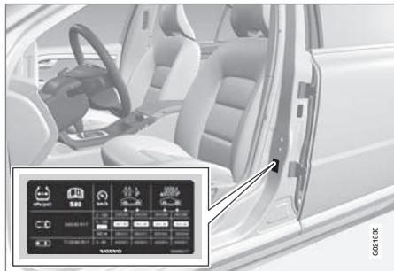
На наклейке, расположенной на дверной стойке со стороны водителя (между передней и задней дверью) указано давление в шинах при различной нагрузке и скоростях. Эта же информация приведена в таблице давления в шинах, см. Шины - заданное давление в шинах (стр. 462).
