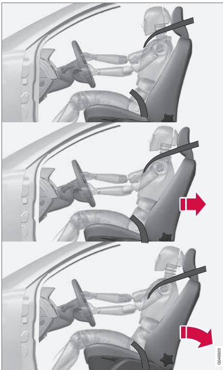
Система WHIPS активируется в момент удара сзади, и ее срабатывание зависит от угла удара, скорости и вида транспортного средства, нанесшего удар.
