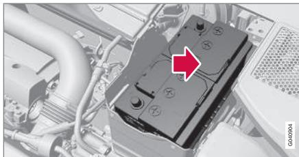
7. Надавив, закрепите заднюю защитную крышку (см. выше раздел "Демонтаж").
