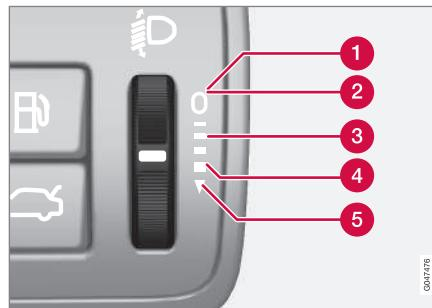
Положения регулировочного кольца при различной загрузке автомобиля.
