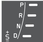
Положения передач в автоматическом режиме показываются в комбинированном приборе с правой стороны. (В каждый момент времени горит только один указатель – для действующего положения селектора передач.)
