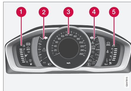
**1** Счетчик топлива. Когда индикатор показывает только одну белую метку<sup>1</sup>, включается желтый контрольный символ низкого уровня топлива в баке. См. также Бортовой компьютер - поясняющая информация (стр. 128) и Заправка топливом (стр. 330).
