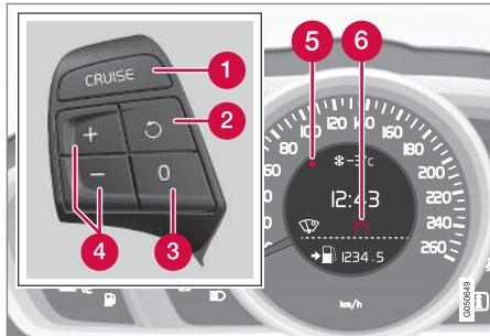
Набор кнопок на рулевом колесе и комбинированный прибор в автомобиле **без** ограничителя скорости<sup>4</sup>.
