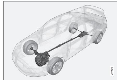
Привод на четыре колеса (All Wheel Drive) означает, что автомобиль приводится в движение одновременно всеми четырьмя колесами.
