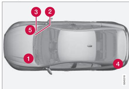
Расположение токораспределительных коробок в автомобиле с левосторонним управлением. В автомобиле с правосторонним управлением токораспределительные коробки под перчаточным ящиком находятся с другой стороны.
