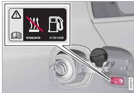
Пробку заливной горловины можно закрепить на крышке.
