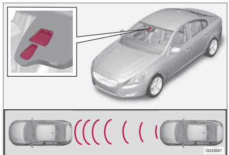
Приемно-выходное окно лазерного датчика<sup>14</sup>.
