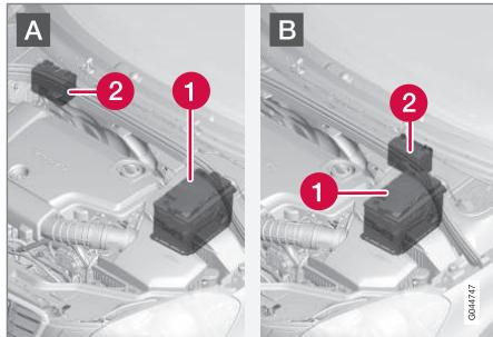
A: Автомобиль с левосторонним управлением. B: Автомобиль с правосторонним управлением. (1) Пусковой аккумулятор<sup>16</sup> (2) Вспомогательный аккумулятор.
