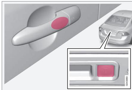
Сенсорная зона на внешних дверных ручках и обрезиненная клавиша около обрезиненной нажимной пластины крышки багажника.
