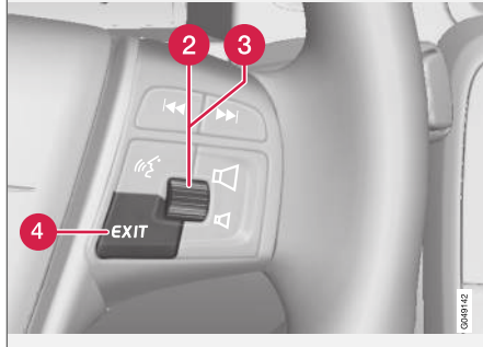
Viduskonsoles vadības panelis un vadības taustiņi uz stūres. Attēls ir shematisks - funkciju skaits un taustiņu
