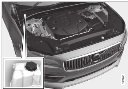
Vase d'expansion du système de refroidissement, voiture à conduite à droite.
