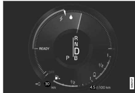
Førerdisplayet ved framdrift med både elektrisk motor og forbrenningsmotor.
