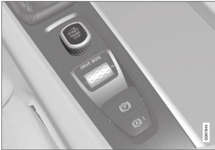
Startbryteren i tunnelkonsollen.
