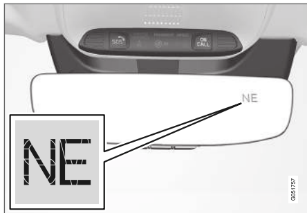
Innvendig speil med kompass.
