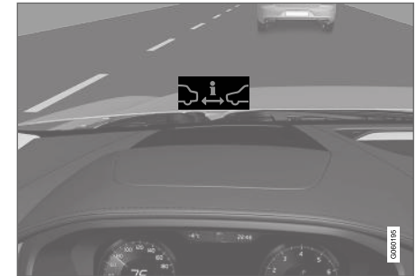
Symbol for Avstandsvarsel på frontruten 37 .
