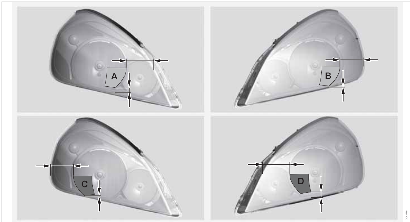
Horní řada: vozy s levostranným řízením, šablony A a B. Dolní řada: vozy s pravostranným řízením, šablony C a D.
