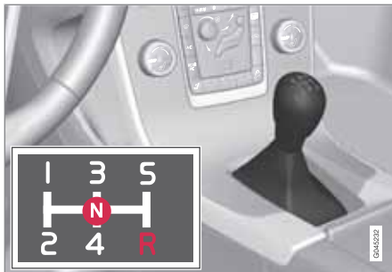
Schéma řazení u pětistupňové převodovky.
