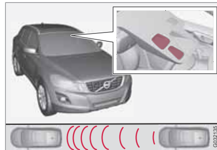
Vysílač a přijímač laserového senzoru v čelním okně 1 .
