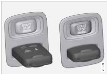
Spínací skříňka s vytaženým/zasunutým dálkovým ovladačem.
