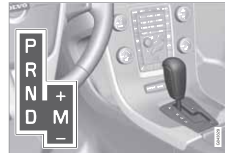
D: polohy automatického řazení. M (+/-): polohy manuálního řazení.
