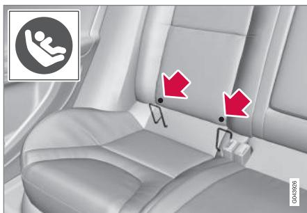
Точки крепления системы ISOFIX спрятаны сзади в нижней части спинки внешних мест заднего сидения.
