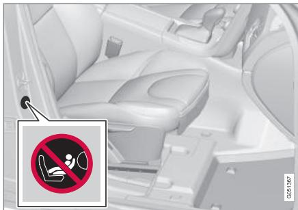
Табличка на дверной стойке со стороны пассажира. Наклейка для подушки безопасности видна, когда открывается пассажирская дверь.
