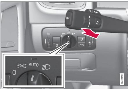
**Подрулевой рычаг и ручка регулировка света в положении AUTO.**
