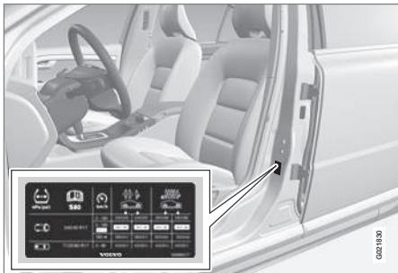
На наклейке, расположенной на дверной стойке со стороны водителя (между передней и задней дверью) указано давление в шинах при различной нагрузке и скоростях. Эта же информация приведена в таблице давления в шинах, см. Шины - заданное давление в шинах (стр. 448).
