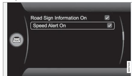
Водитель может выбрать, следует ли получать предупреждение, когда действующее ограничение скорости превышается на 5 км/ч (5 миль/ч) или больше. Предупреждение о превышении скорости выдается в виде мигающего символа с указанием текущей максимальной скорости. Функцию можно активировать/отключить в системе меню **MY CAR**. Описание системы меню - см. **MY CAR** (стр. 122).
