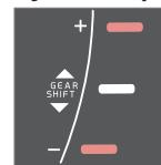
Индикатор переключения передач для механической коробки передач. В каждый момент времени горит только один указатель – при движении в обычном режиме горит только указатель в центре.
