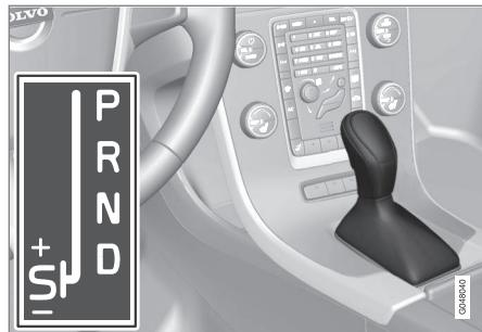
**D:** Положения передач в автоматическом режиме. **+/-:** Положения передач в ручном режиме. **S:** Режим Sport\*.
