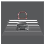
Вы можете выбрать разный временной интервал до автомобиля впереди вас, который отображается в комбинированном приборе в виде 1-5 горизонтальных штрихов – чем больше штрихов, тем больше временной интервал. Один штрих соответствует прим. 1 секунде до автомобиля перед вами, 5 штрихов – прим. 3 секундам.
