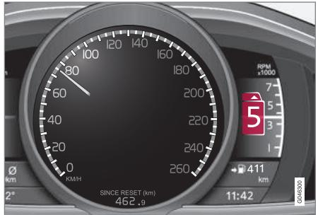
Комбинированный прибор "Digital" с индикатором переключения передач.
