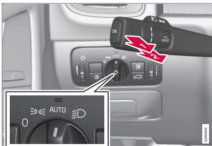
Подрулевой рычаг и ручка регулировки света.
