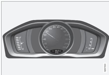
Информацию с бортового компьютера можно вывести на информационный дисплей комбинированного прибора<sup>28</sup>.
