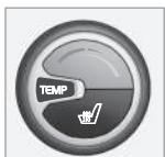
Этой ручкой устанавливается температура – отдельно на стороне водителя и пассажира.
