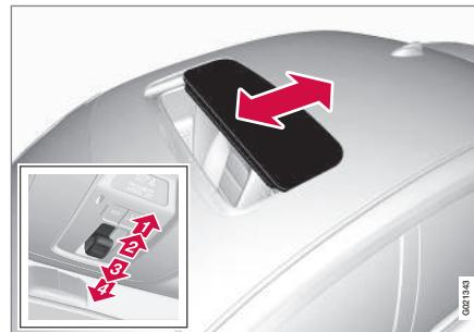
комфортного положения до тех пор, пока кнопка управления нажата. Вновь потяните регулятор назад, чтобы максимально открыть люк.
