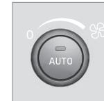
Для увеличения уменьшения скорости вентилятора поверните ручку. При выборе AUTO скорость вращения вентилятора регулируется автоматически (стр. 143) - ранее установленные значения скорости вращения вентилятора отключаются.
