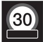
Символ дополнительной таблички в виде пустой рамки под символом скорости в комбинированном приборе означает, что система RSI обнаружила для данного ограничения скорости табличку с дополнительной информацией.
