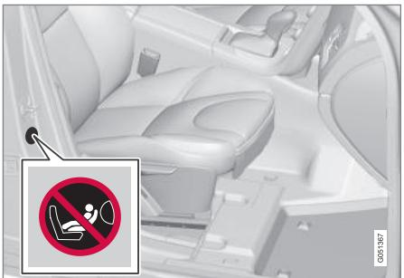
Табличка на дверной стойке со стороны пассажира. Наклейка для подушки безопасности видна, когда открывается пассажирская дверь.
