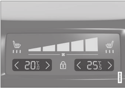
Temperatuurregeling op klimaatpaneel achter op tunnelconsole.
