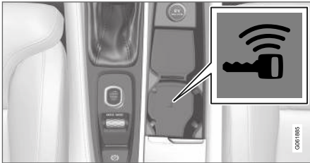
Positie back-uplezer in de tunnelconsole.
