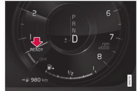
La fonction est active et le moteur est automatiquement arrêté.
